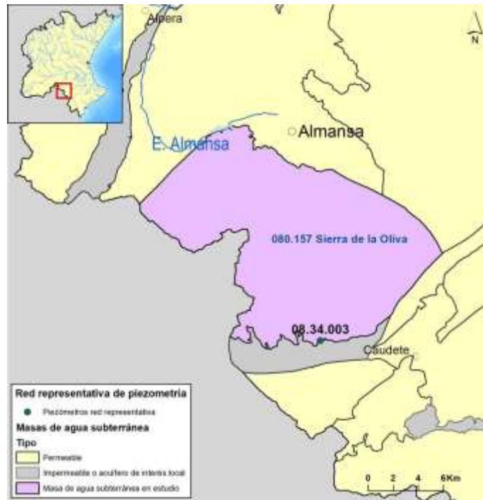
Figura 120. Red representativa en la masa de agua subterránea 080.157 Sierra de la Oliva.
