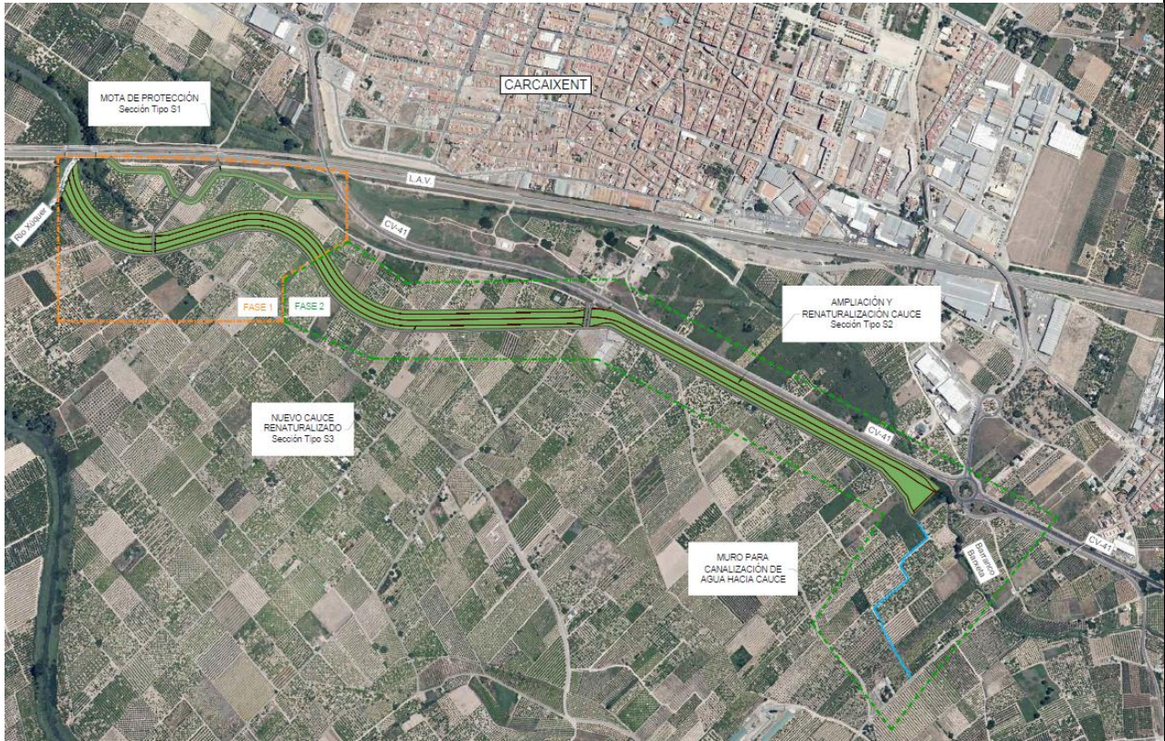
Obras previstas en adaptación al riesgo de inundación del Barxeta, fases I y II
