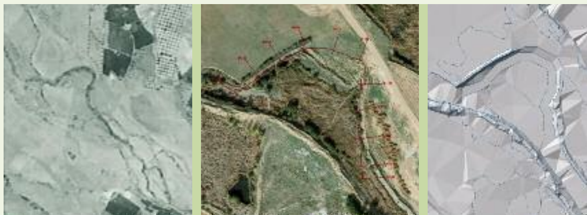
Figura 4.17 La primera imagen, correspondiente al vuelo aéreo realizado en 1956, muestra el aspecto original del meandro. La segunda imagen muestra el aspecto actual del meandro. Gracias a la ayuda de un modelo digital de elevación del terreno, se ha reconstruido el meandro y se han calculado los volúmenes de tierra a mover y el perímetro a reperfilear para alcanzar la imagen objetivo (imagen derecha).
