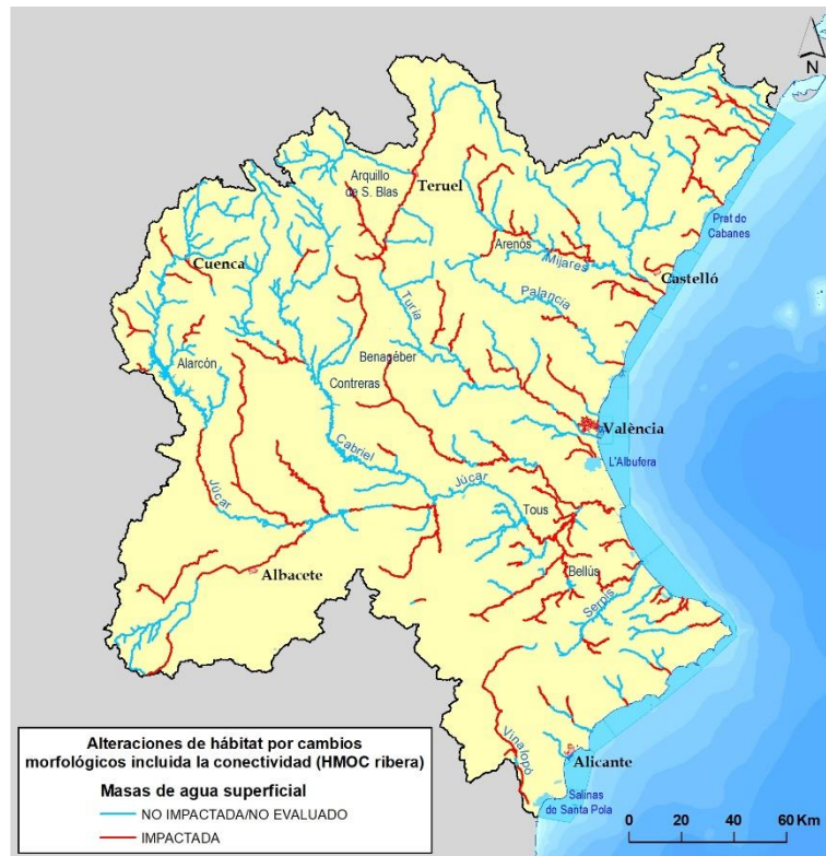
Figura 3. Masas de agua superficial impactadas por alteraciones de hábitat por cambios morfológicos debidos a la calidad de ribera.
