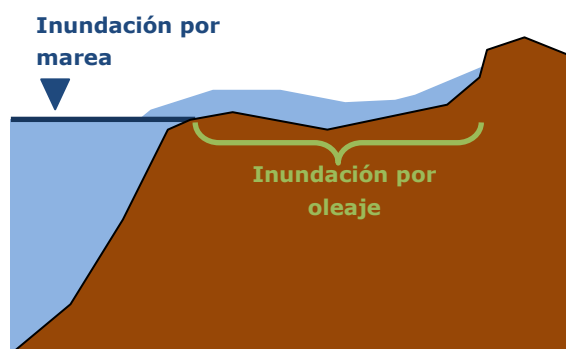
Figura 10. Esquema de inundación por marea e inundación por oleaje.
