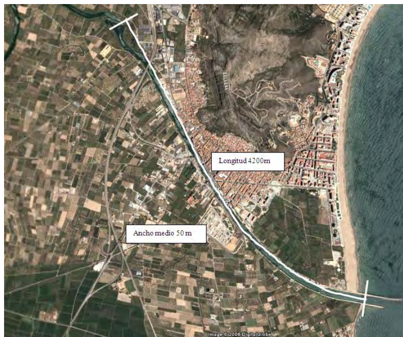
Figura 2. Vista aérea del tramo final del río Júcar con sus principales características geométricas.
