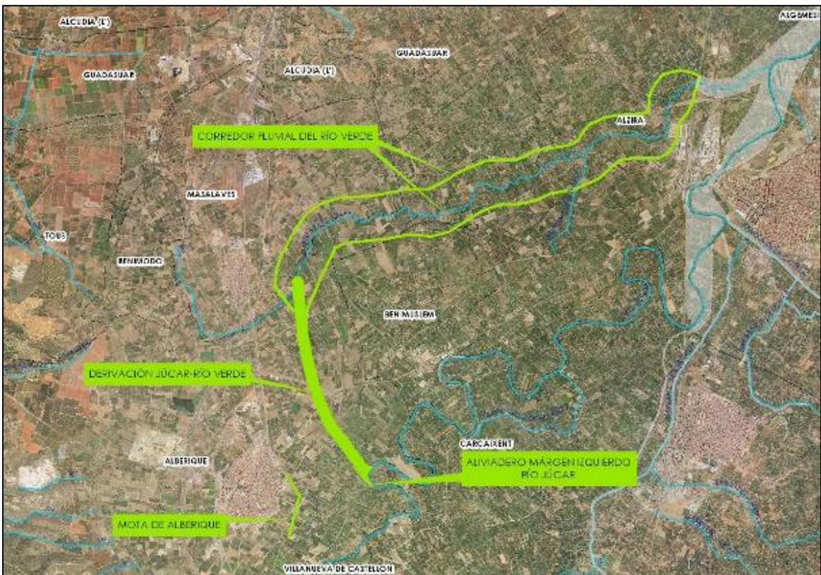
Figura 11. Obras de alivio de caudales del río Júcar hacia el río Verde.
