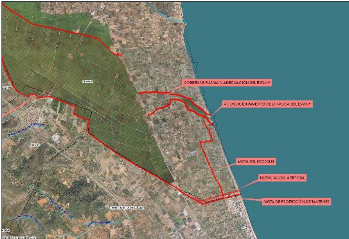
*Figura 8. Obras de mejora de salida de caudales a través de l'Estany de Cullera..*
