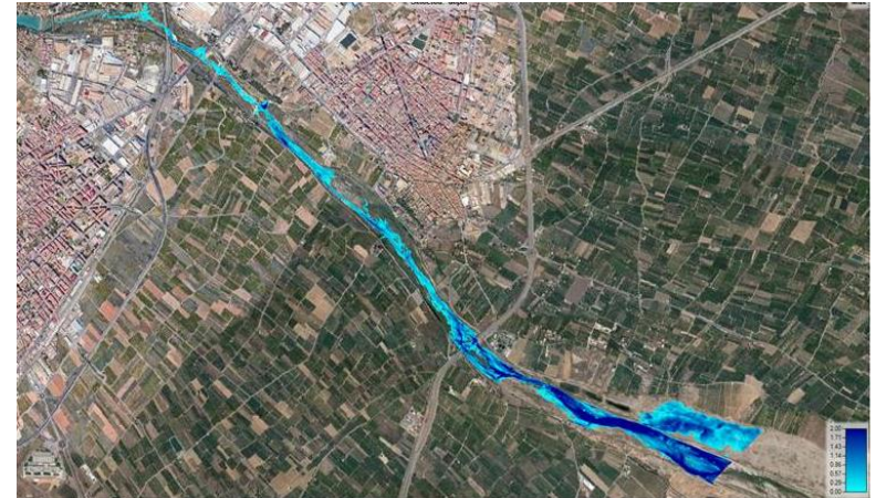
Análisis hidráulico mediante sueltas controladas en el tramo bajo del Mijares
