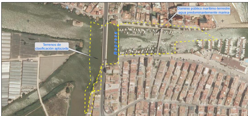
Ilustración 1: El uso de la fotointerpretación ha resultado relevante para determinar el carácter ajeno al Dominio público hidráulico de ciertos terrenos sobre los que se alzaban edificaciones ahora inexistentes.
