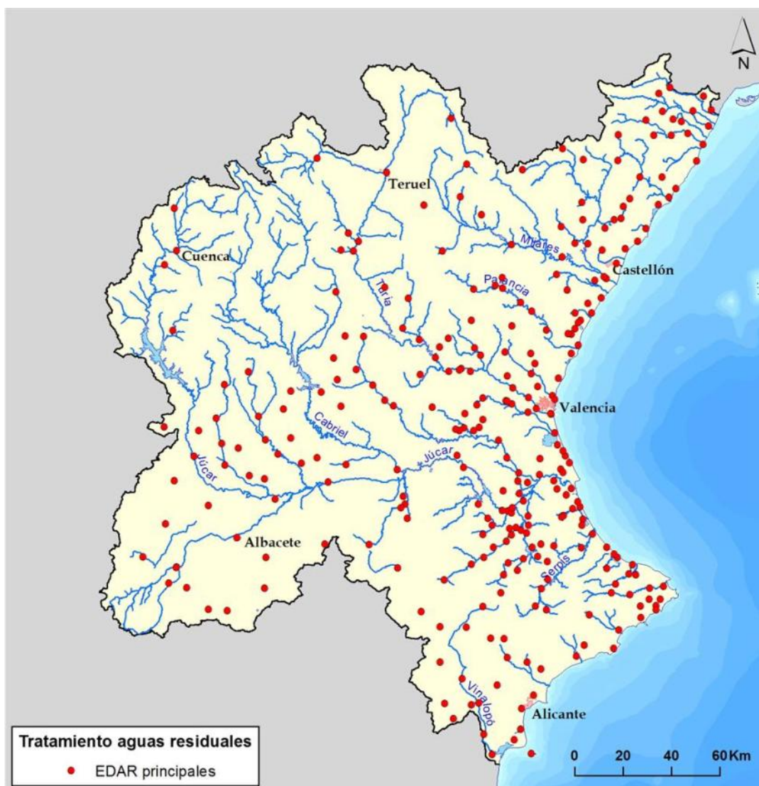
Principales Estaciones Depuradoras de Aguas Residuales en la DHJ.
