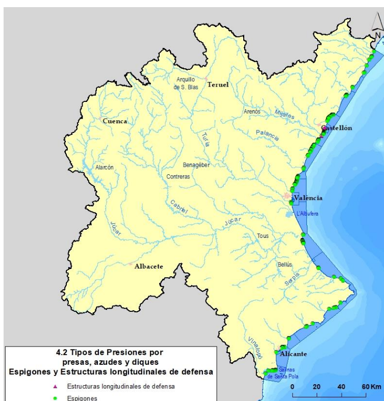
Figura 13. Espigones y estructuras longitudinales de defensa vinculadas a masas de agua superficial incluidos en el inventario de presiones.
