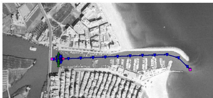
Figura 28. Modelo hidráulico de la gola del Perelló
