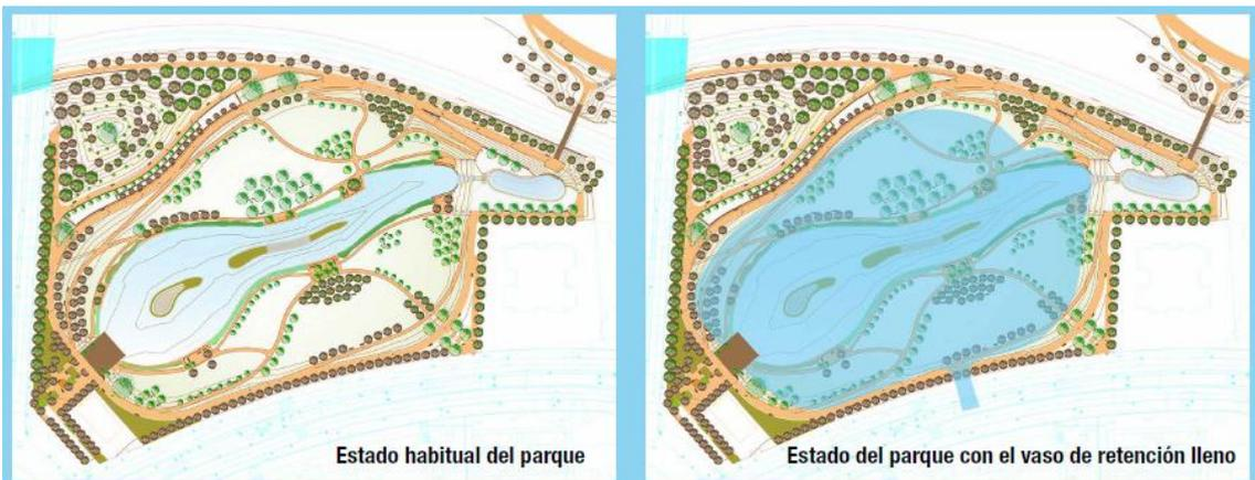
Figura 18. Vista panorámica del parque La Marjal de Alicante y simulación de su funcionamiento como vaso de retención de pluviales (Fuente: Fundación Aquae, 2018 y Ayuntamiento de Alicante<sup>2</sup>)
