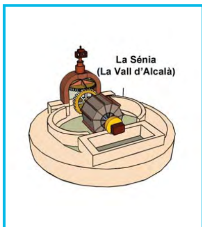
Esquema de una Noria de Sangre o de tracción animal
