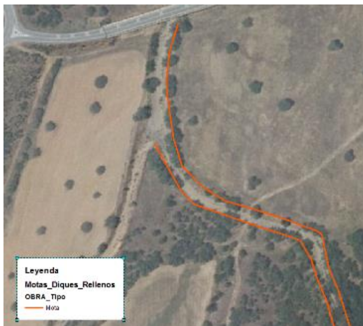
Figura 22.-Determinación cartográfica y atributos SIG de obras de protección frente a inundaciones.
