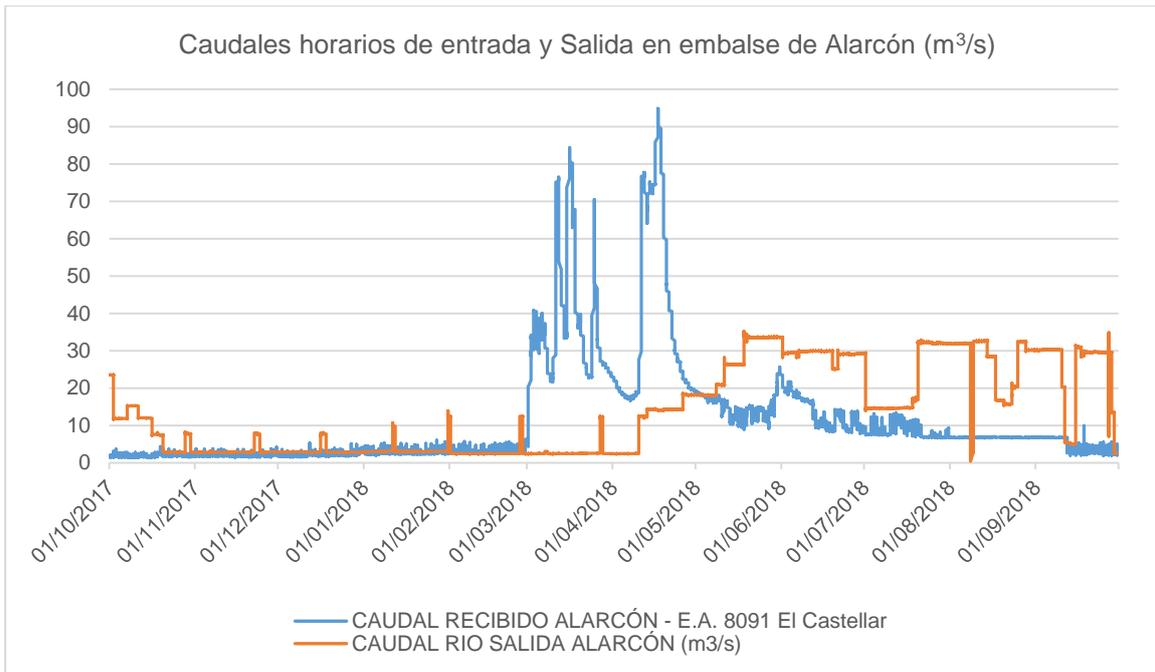
Figura 9. Entrada vs Salida del embalse de Alarcón. Régimen muy alterado hidrológicamente.
