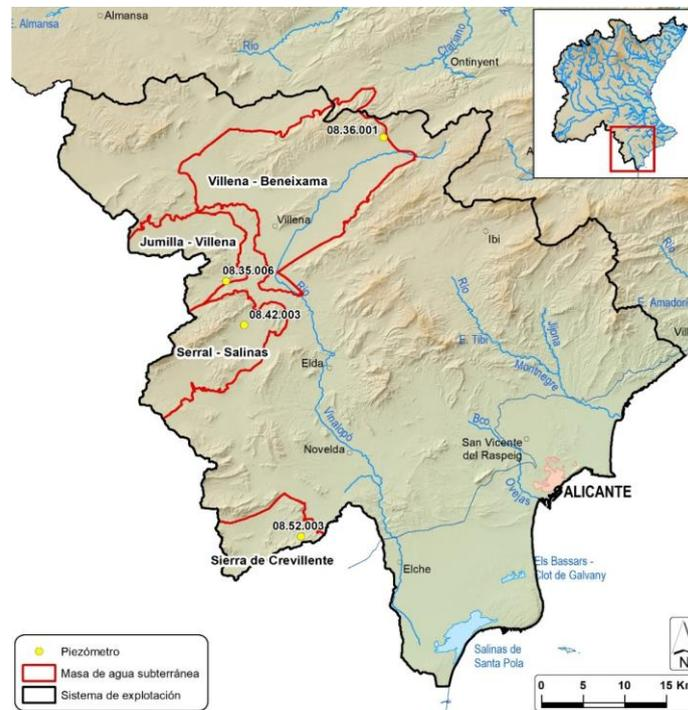
Figura 109. Situación de los piezómetros 08.36.001, 08.35.006, 08.42.003 y 08.52.003 en el sistema Vinalopó-Alacantí.
