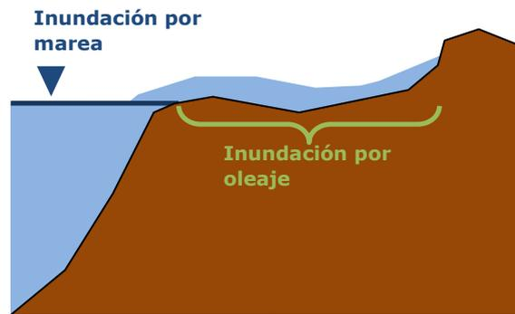
Figura 37. Esquema de inundación por marea e inundación por oleaje.
