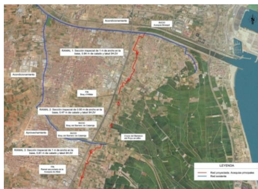
Figura 6. Obras de Reord. de la IH de la huerta y red de Saneamiento del área metropolitana de Valencia
