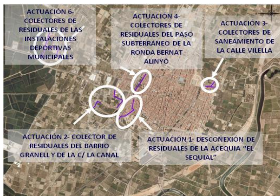
Figura 11. -Obras de mejora de la red de saneamiento de Sueca (Valencia)
