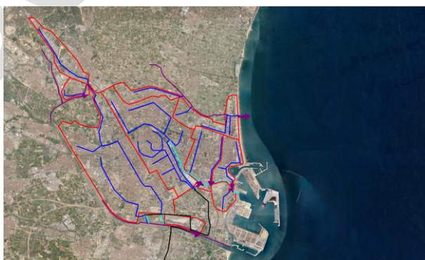
Figura 13. Esquema de cuencas, colectores y puntos de vertido del Saneamiento de Valencia
