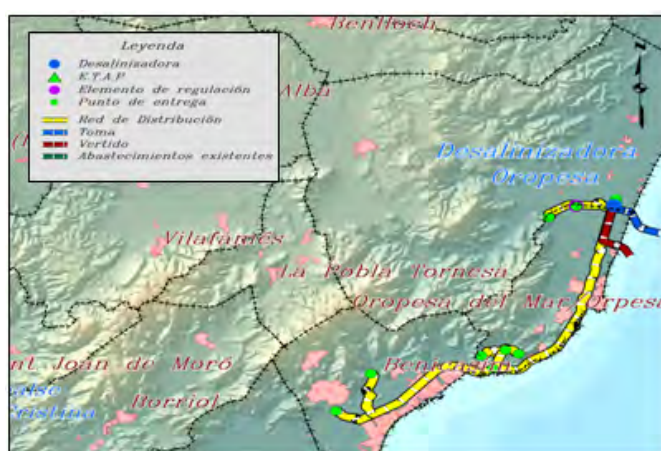
Figura 7. Desaladora de Oropesa. Planta de actuaciones.
