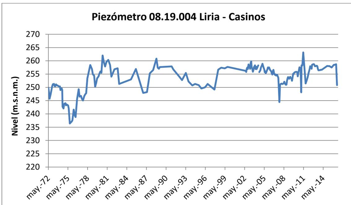
Figura 198. Evolución del nivel piezométrico en la masa de agua 080.131 Liria-Casinos.
