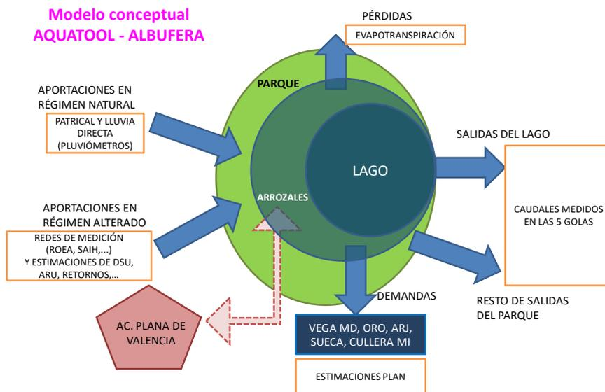
Figura 8. Representación esquemática del funcionamiento del modelo Aquatool-Albufera.
