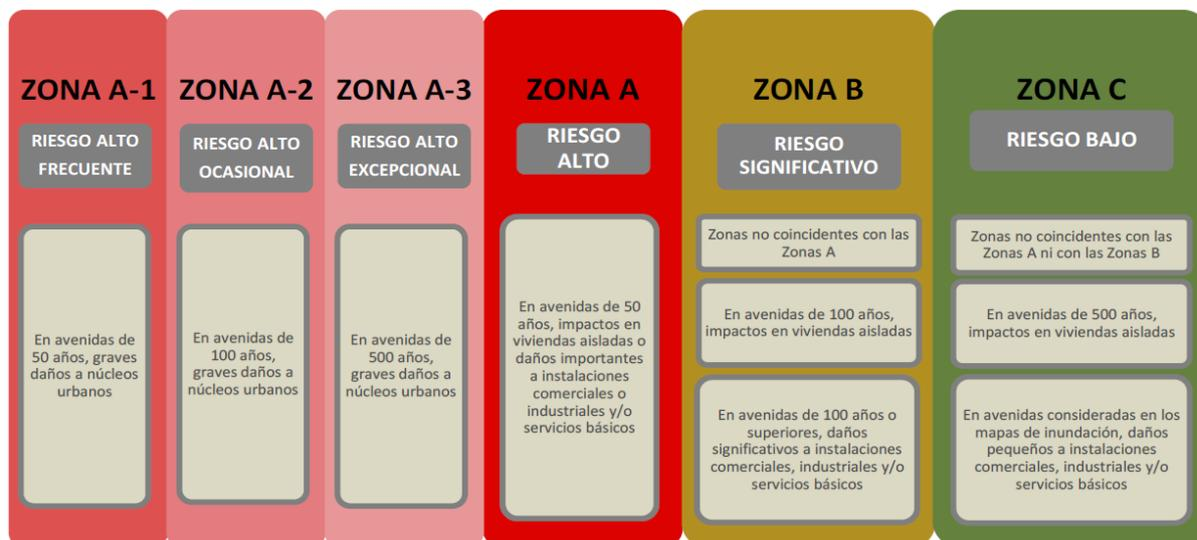
Figura 70.- Zonificación del riesgo de inundación según Directriz Básica de Planificación de Protección Civil
