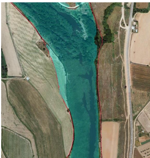
Figura 36. Delimitación de cauce actual a partir del análisis de la fotografía aérea, las evidencias topográficas y el estudio hidráulico.
