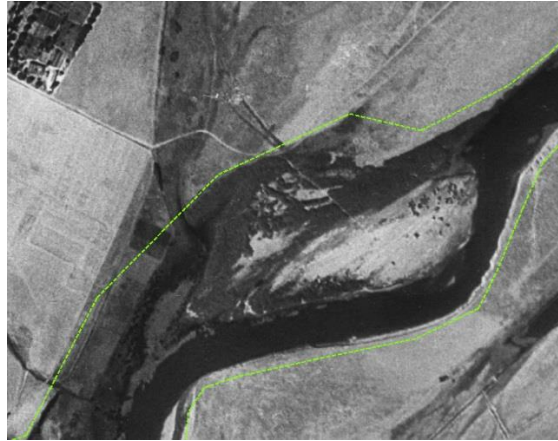
Figura 32. Delimitación de cauce histórico incluyendo una zona con importante actividad fluvial (depósito de sedimento) con presencia parcial de vegetación, y susceptible de ser inundado.
