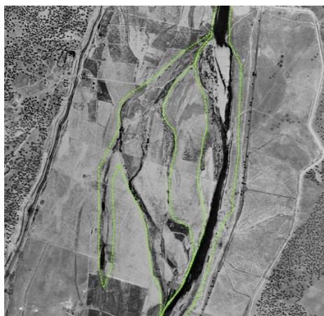
Figura 33. Delimitación de cauce histórico en tramo trezado donde se observa una zona con brazos secundarios parcialmente desconectados. En etapas posteriores se valora su clasificación en el DPHP.
