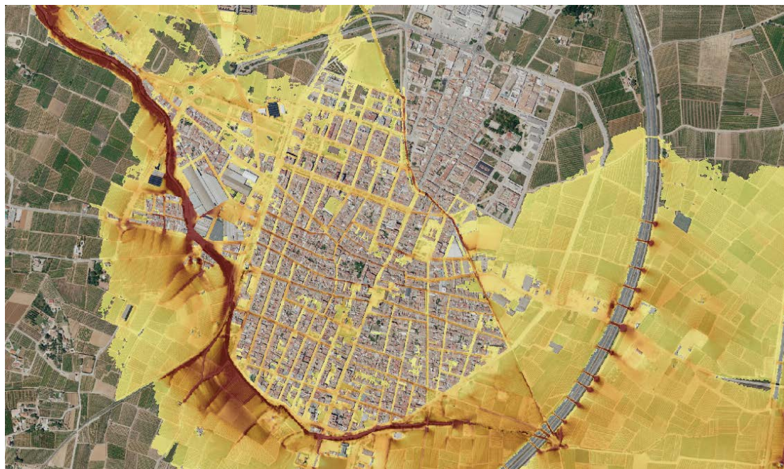
Figura 14. Ejemplo de velocidades obtenidas en la modelización del subtramo ES080_ARPS_0014-17 a su paso por el municipio de Alginet.
