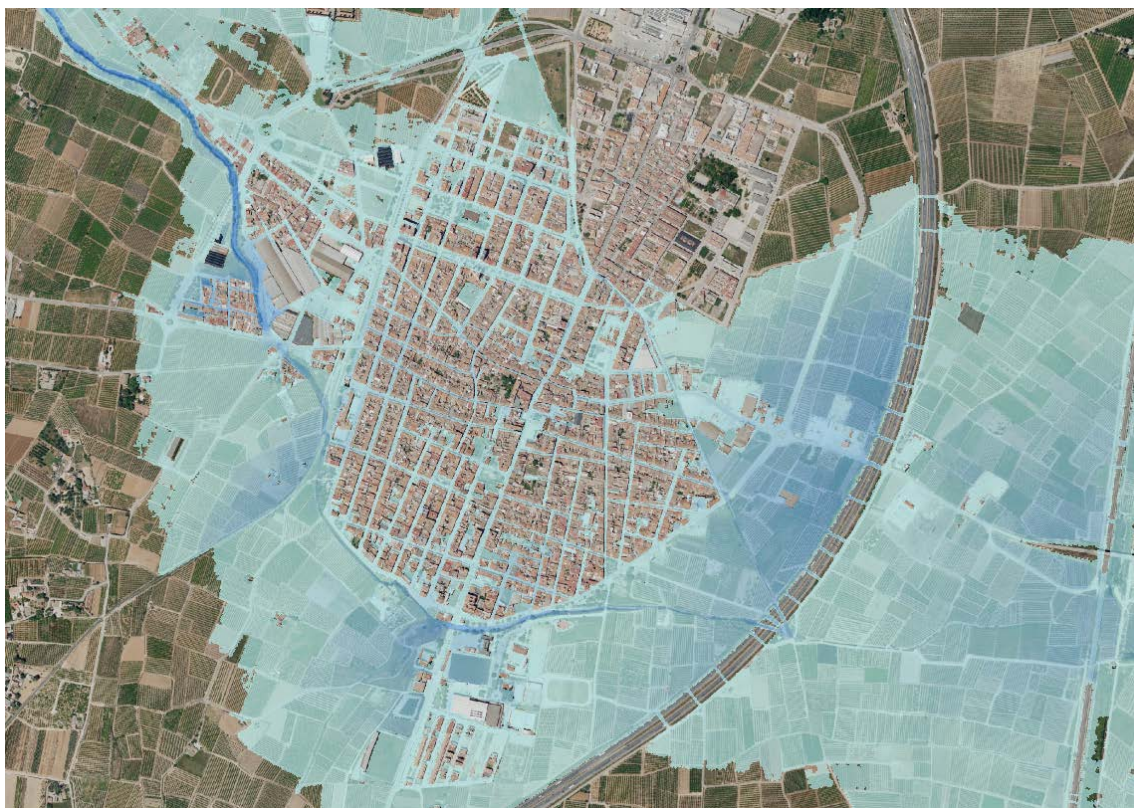
Figura 13. Ejemplo de velocidades obtenidas en la modelización del subtramo ES080_ARPS_0014-17 a su paso por el municipio de Alginet.
