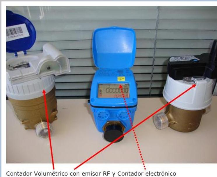
Contador Volumétrico con emisor RF y Contador electrónico
