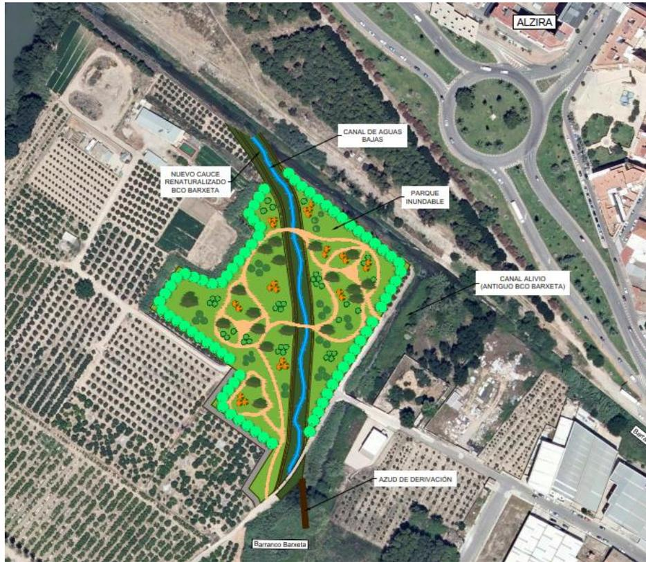
Figura 3. Planta de zona de laminación propuesta
