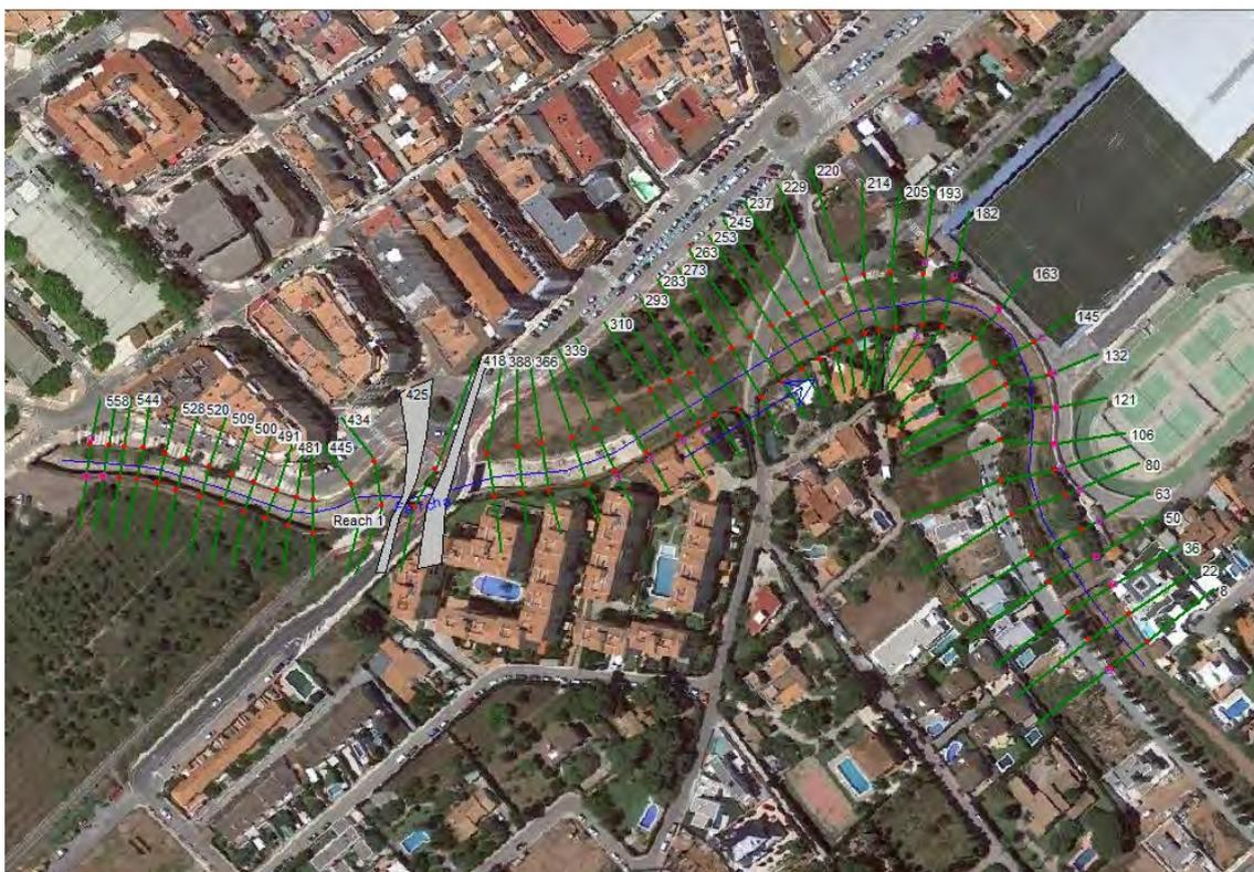
**Figura 7. Secciones trasversales del modelo hidráulico.**
