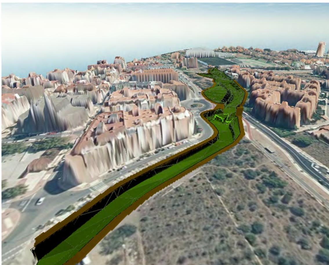
Figura 3. Modelo digital del terreno (MDT) realizado a partir del levantamiento topográfico para la caracterización de la geometría del cauce.
