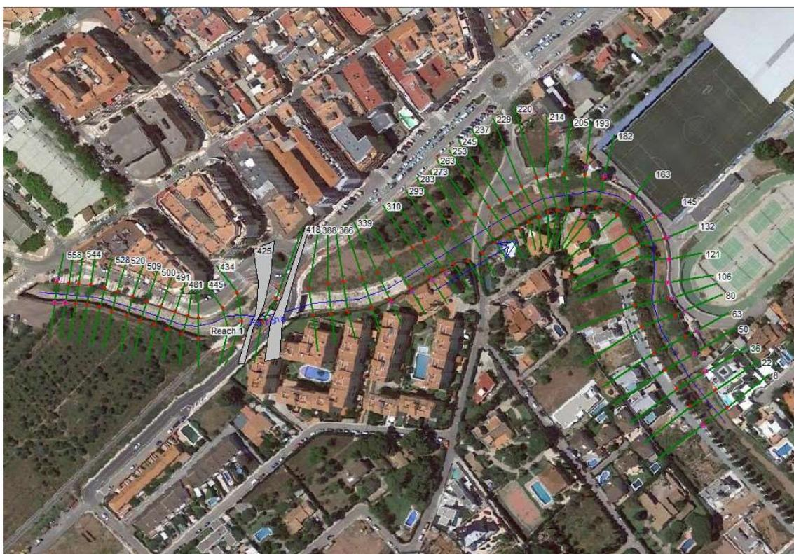
Figura 7. Secciones transversales del modelo hidráulico.
