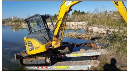
**Salida de la retroexcavadora utilizando rampa auxiliares**
