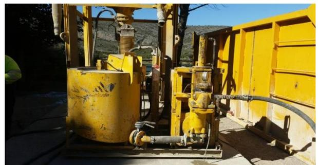
Mezcladora y de la bomba de inyección de la lechada
