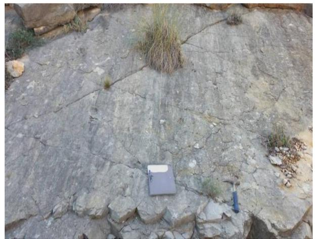
Estación geomecánica realizada sobre los taludes del macizo del estribo derecho
