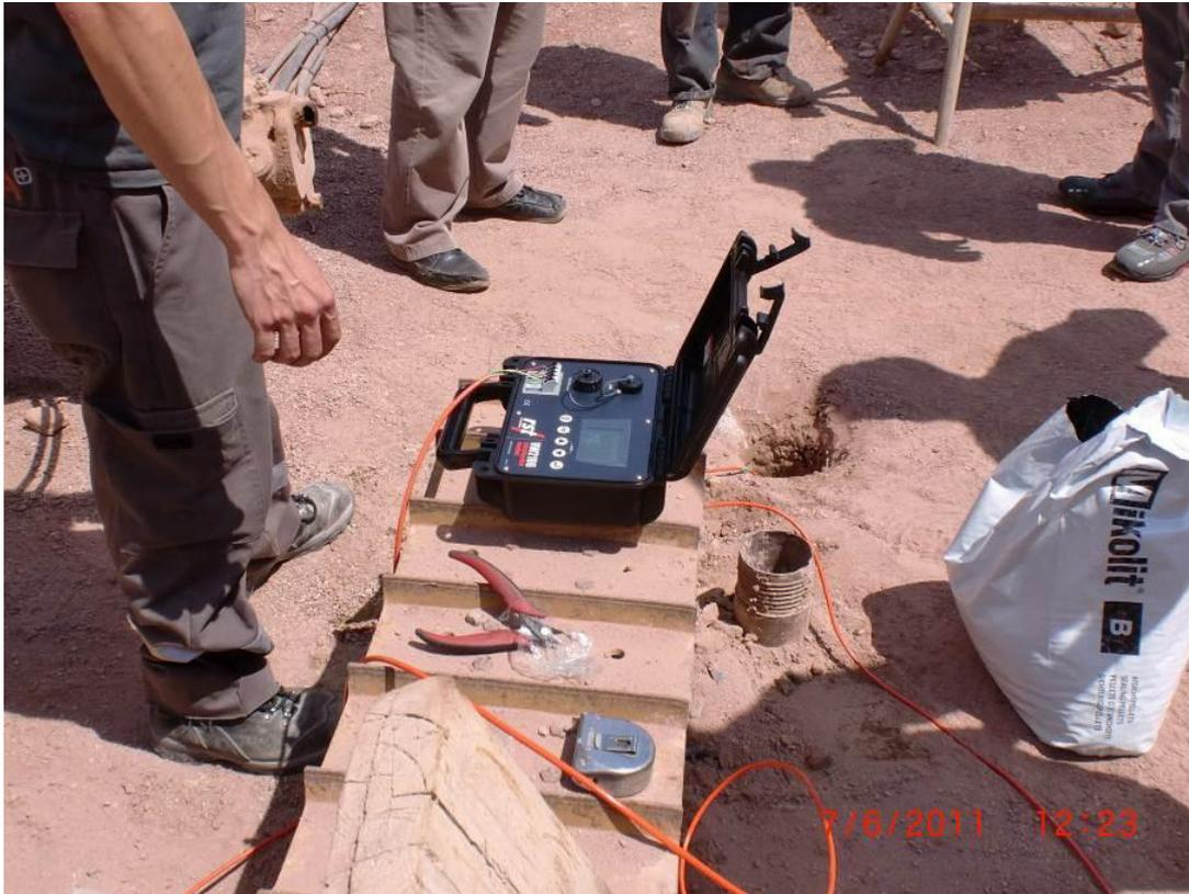
Comprobación del funcionamiento de un piezómetro de cuerda vibrante recién instalado
