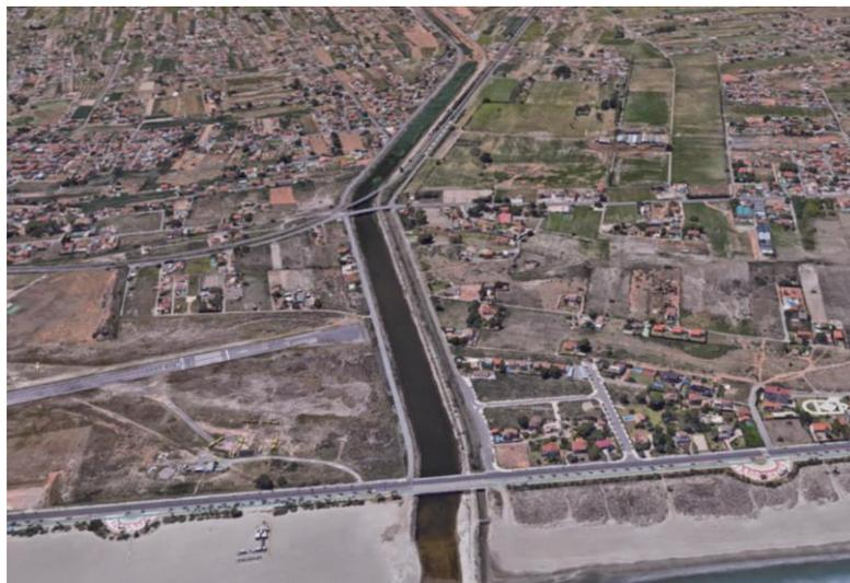
Figura 61. Vista aérea del encauzamiento del río Seco en su desembocadura (Fuente: Google Earth).
