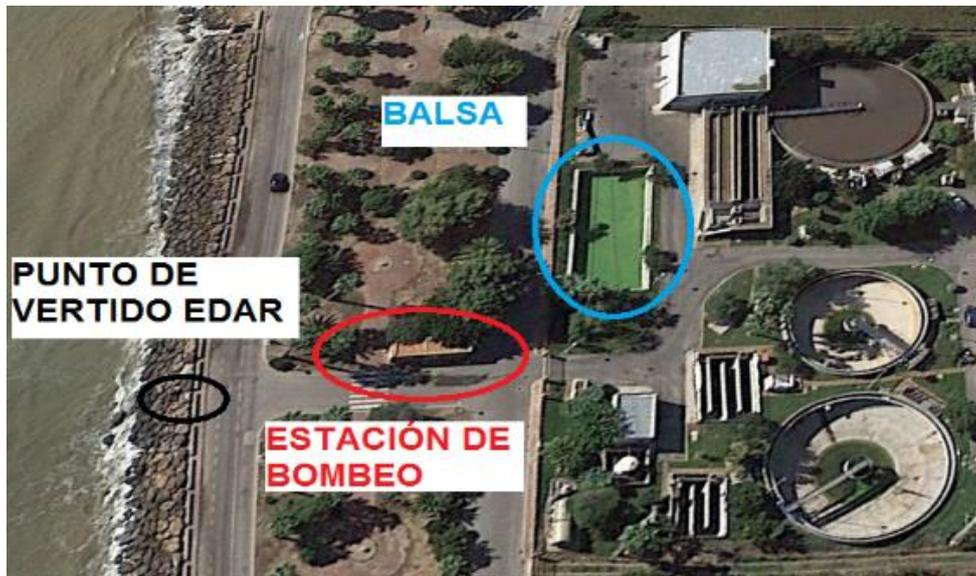
Figura 26. Depuradora de Borriana, situación de la balsa y la Estación de Bombeo de los regantes.
