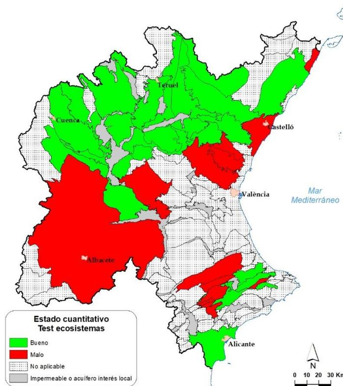
Figura 95. Estado cuantitativo de las masas de agua subterránea según el test de EDAS.
