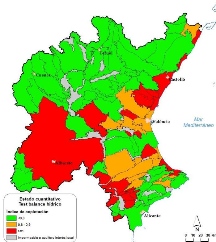
Figura 91. Índice de explotación por masa de agua subterránea.
