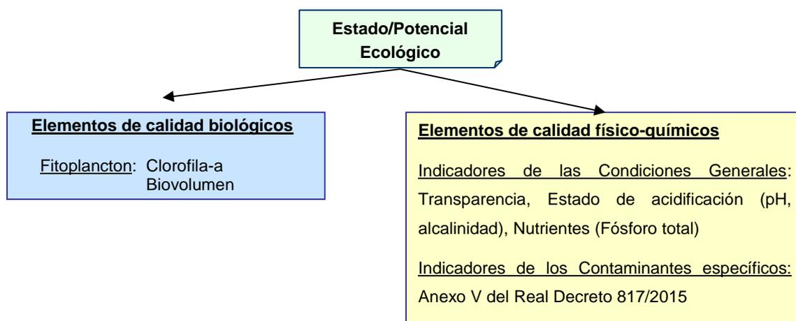
Figura 17. Indicadores empleados para la determinación del estado – lagos (no embalses)
