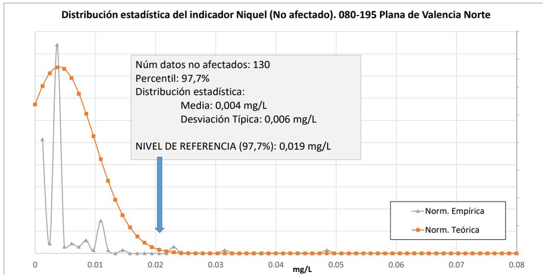
Figura 112. Gráfica del cálculo del nivel de referencia del indicador Níquel en la masa de agua subterránea 080-195 – Plana de Valencia Norte
