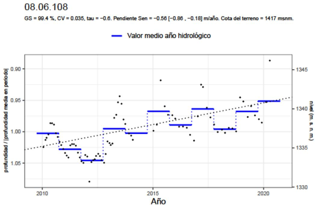
Figura 87. Profundidad normalizada y estadísticos de análisis del test Mann-Kendall y pendiente Sen en el piezómetro 08.06.108.
