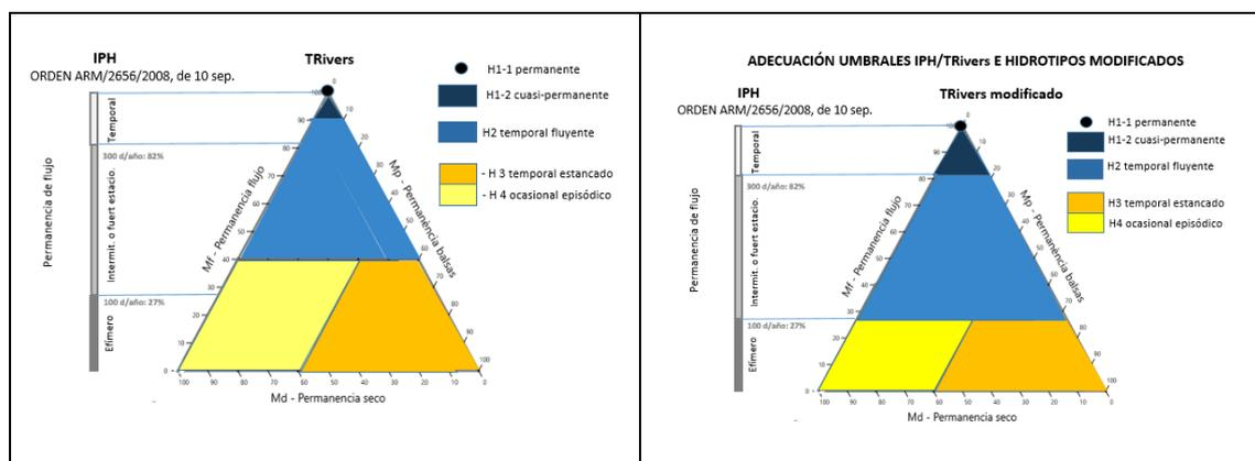
Figura 3. Adaptación de hidrotipos modificados en función de la temporalidad en régimen natural establecida por la IPH (izq:hidrotipos según TREHS. Dcha: hidrotipos adaptados según temporalidad IPH)
