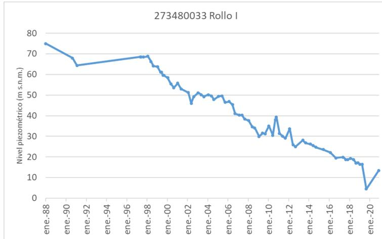
Figura 92. Evolución piezométrica del sondeo Rollo I en la masa subterránea 080-210 Sierra de Argallet. Fuente Diputación de Alicante.
