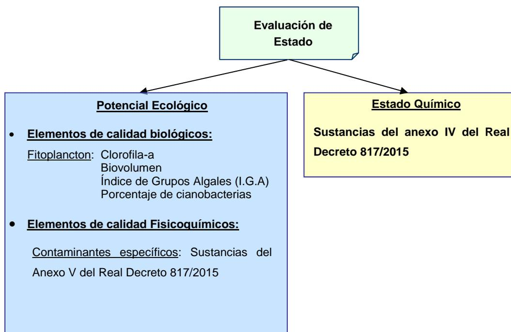
Figura 16. Indicadores empleados para la determinación del estado – Embalses (masas de agua muy modificadas y artificiales por la presencia de presas)
