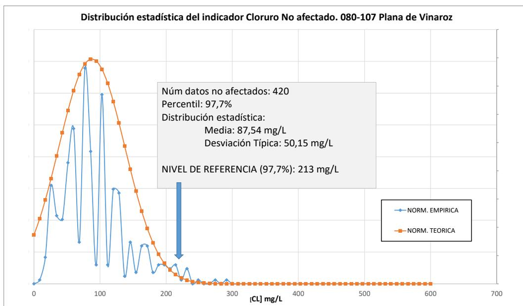
Figura 111. Gráfica del cálculo del nivel de referencia del indicador cloruros en la masa de agua subterránea 080-107 Plana de Vinaroz
