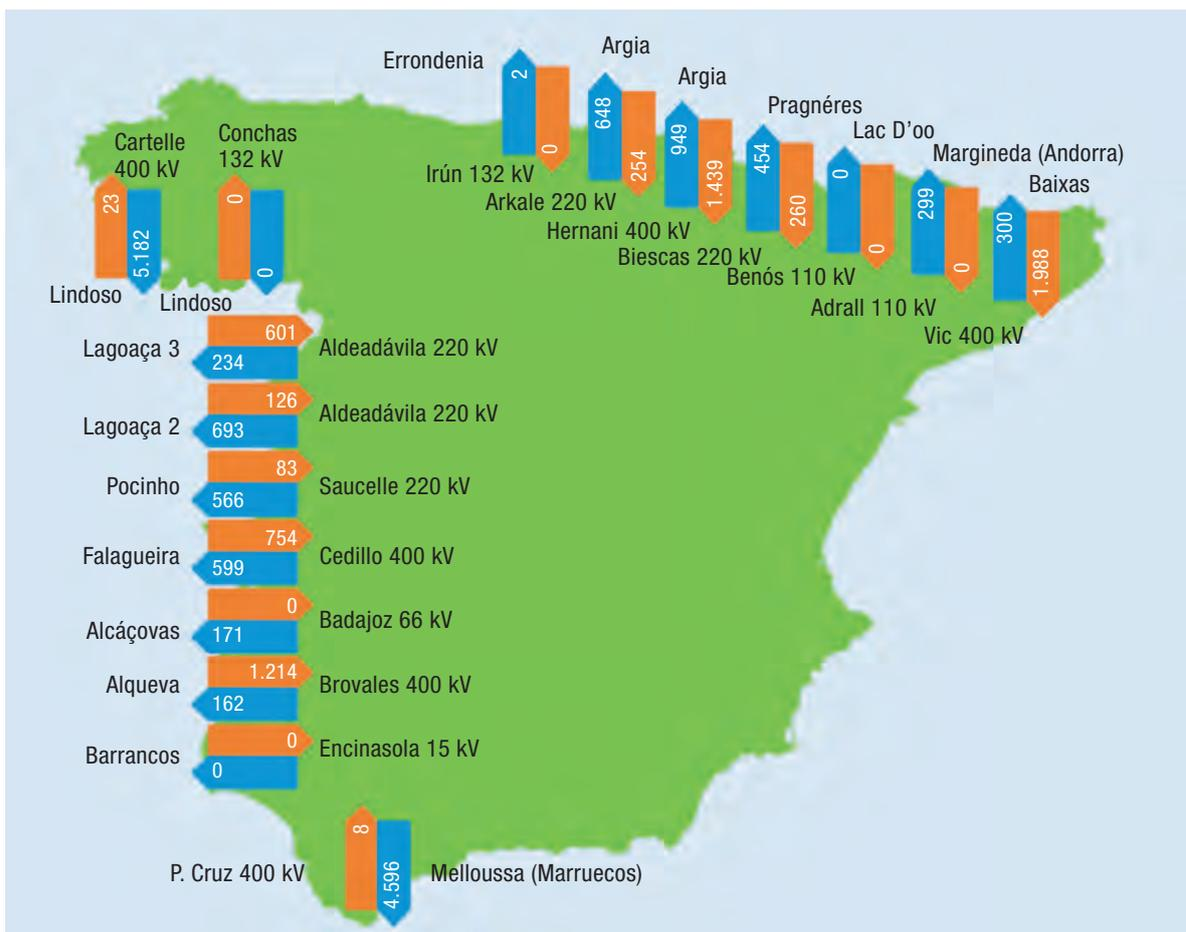
Figura 2.2.31. Intercambios internacionales físicos de energía eléctrica en el año 2009 (GWh). Fuente: REE
