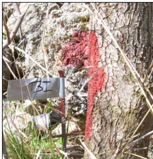
Figura 56. Ejemplo de varilla clavada y marcada en el transecto 3 de la orilla izquierda en el río Júcar.
