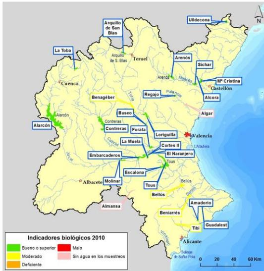
Figura 76. Resultado de los Indicadores biológicos en 2010- Embalses (masas de agua muy modificadas o artificiales por la presencia de presas)
