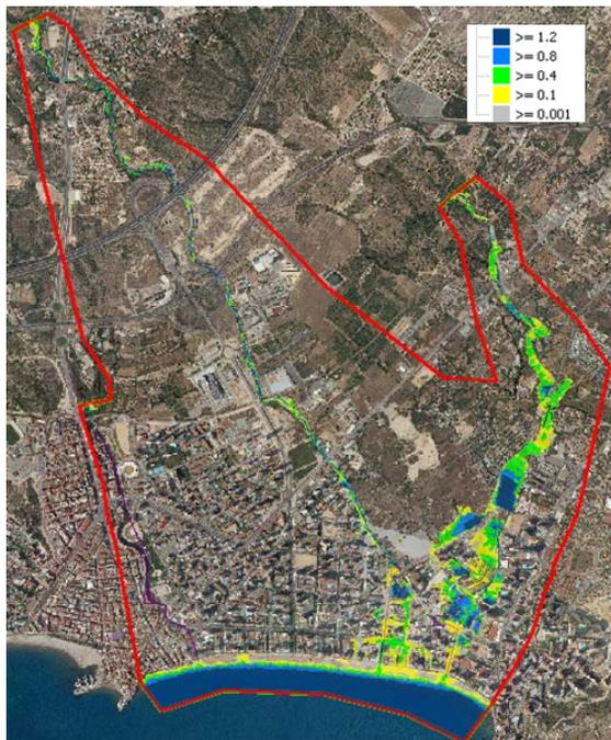
En el caso del Murtal y Xixó, únicamente hay problemas en la desembocadura del colector del Barranc de Murtal cuyo caudal desaguado afecta a viviendas con calados de hasta 80cm.
