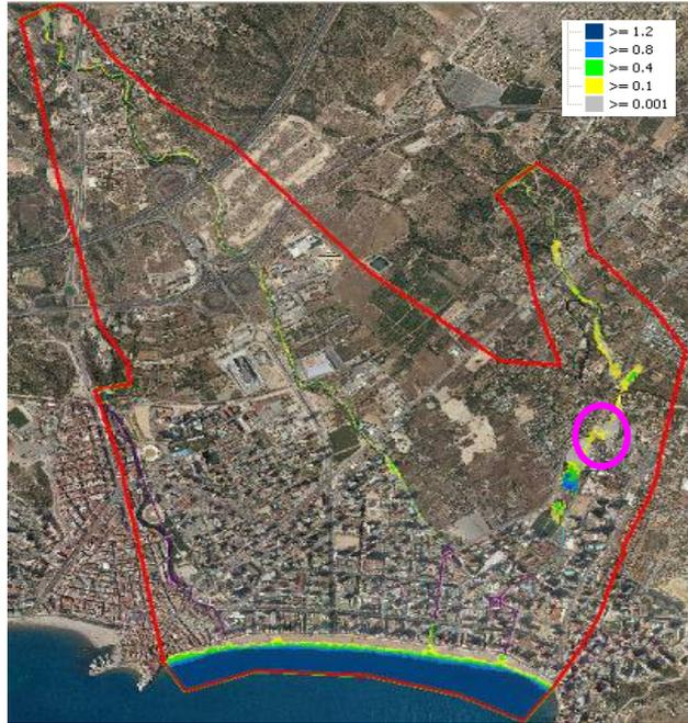
Para este periodo de retorno no se producen desbordamientos en el Barranc de Xixo (barranco ubicado al este del modelo) teniendo éste y el colector de la desembocadura suficiente capacidad, el colector desagua en la playa, sin originar problemas
