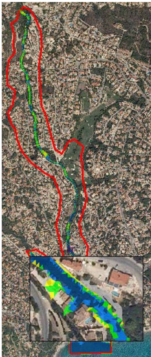
Figura 217: Simulación modelo Benissa 1 para periodo de retorno T50. Detalle desbordamiento
