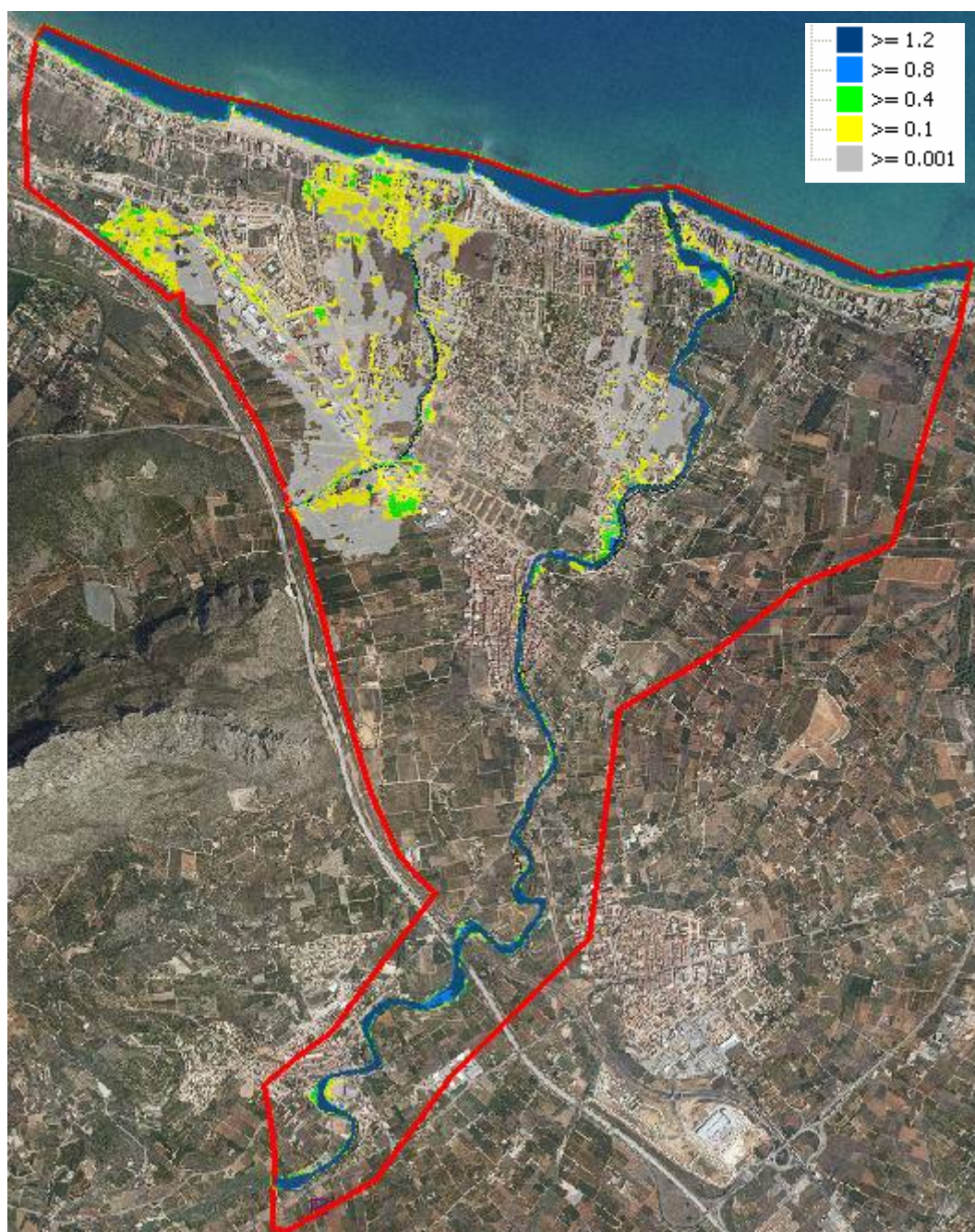
Figura 51: Simulación submodelo río Girona para periodo de retorno T10
