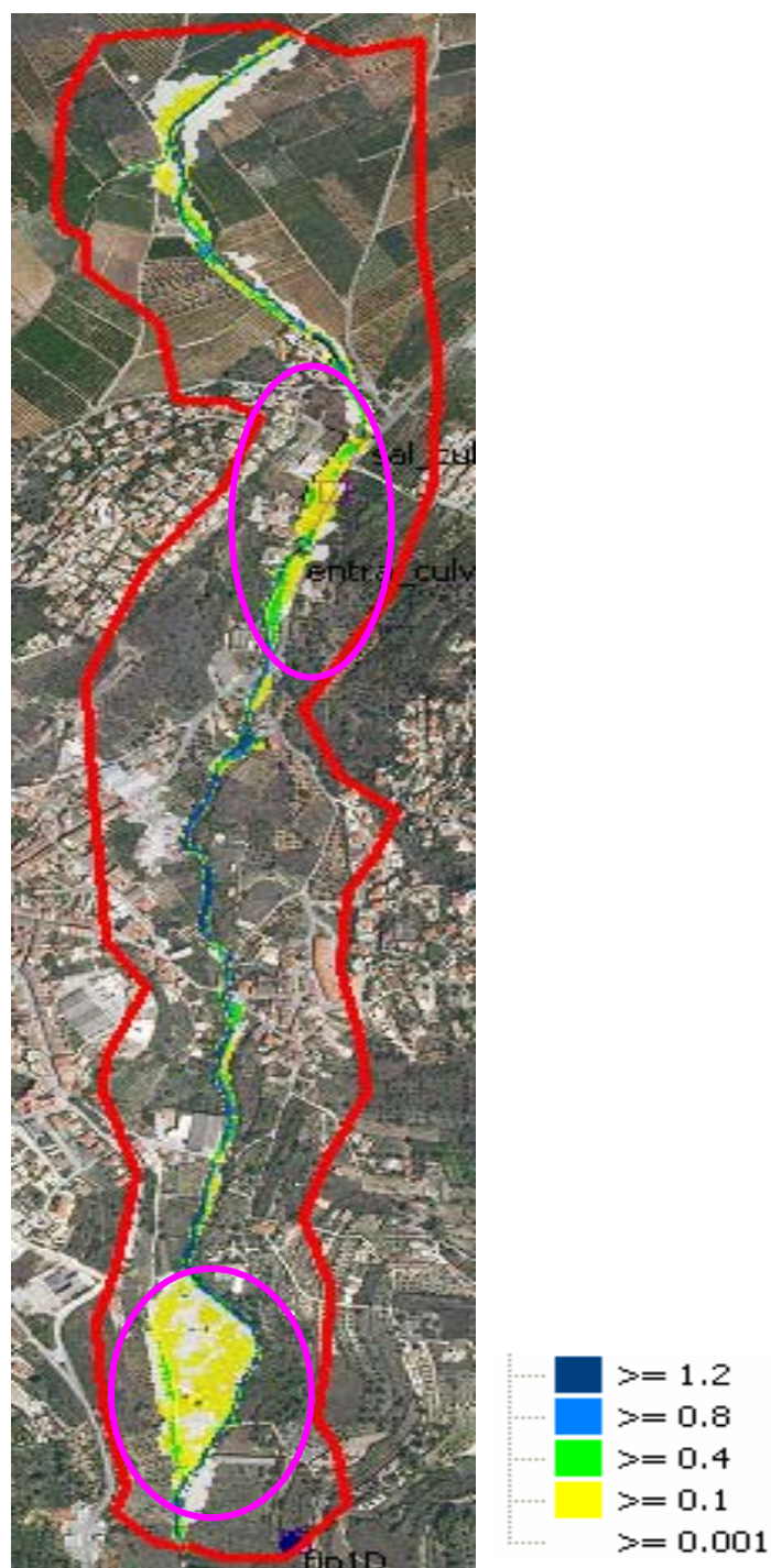
Figura 166: Simulación del modelo barranco de Orbeta para un periodo de retorno T10.
