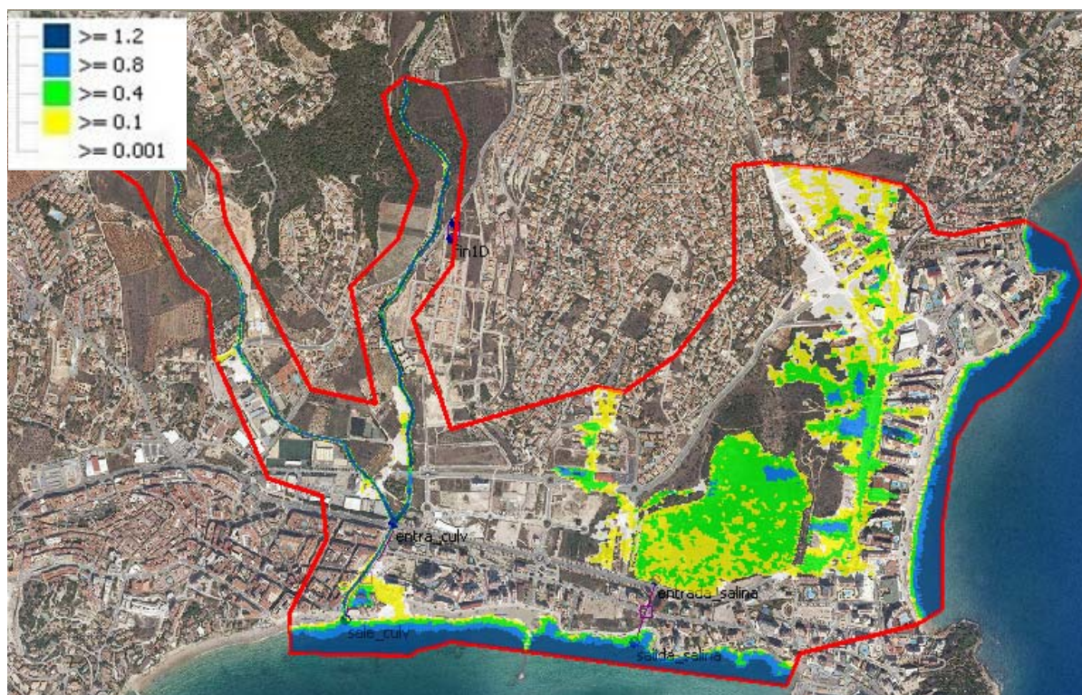
Figura 247: Simulación modelo Calp para periodo de retorno T10.
