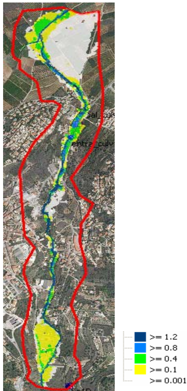
Figura 171: Simulación del modelo barranco de Orbeta para un periodo de retorno T50.
