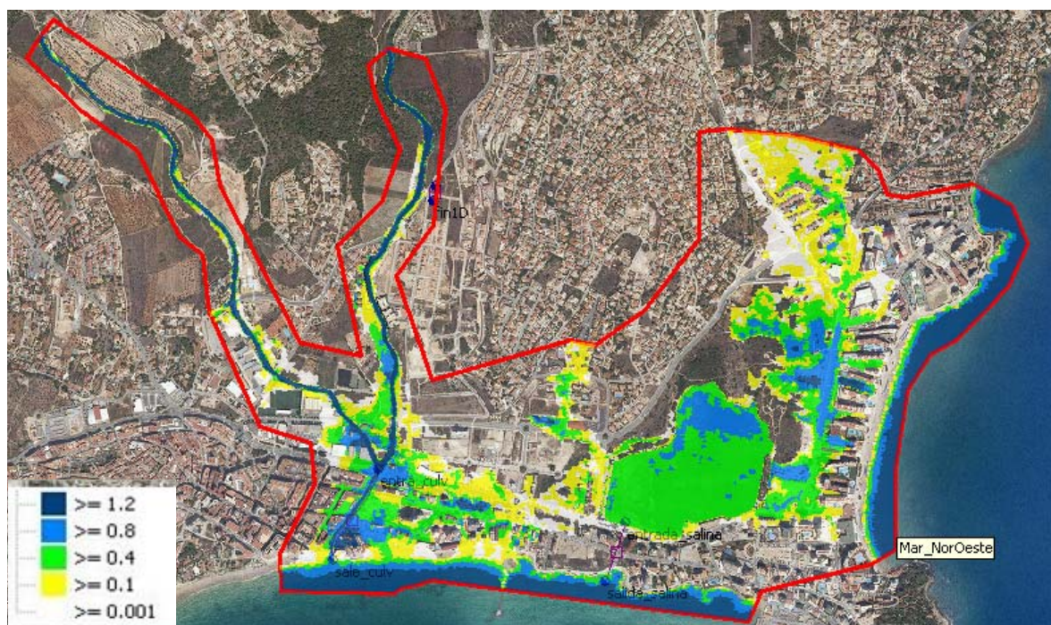
Figura 257: Simulación modelo Calp para periodo de retorno T50.
