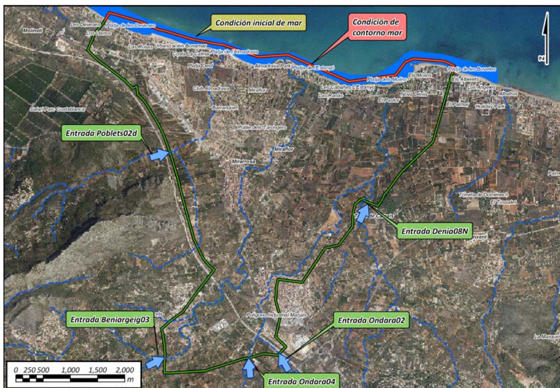
Figura 46: Condiciones de contorno e iniciales del modelo general
