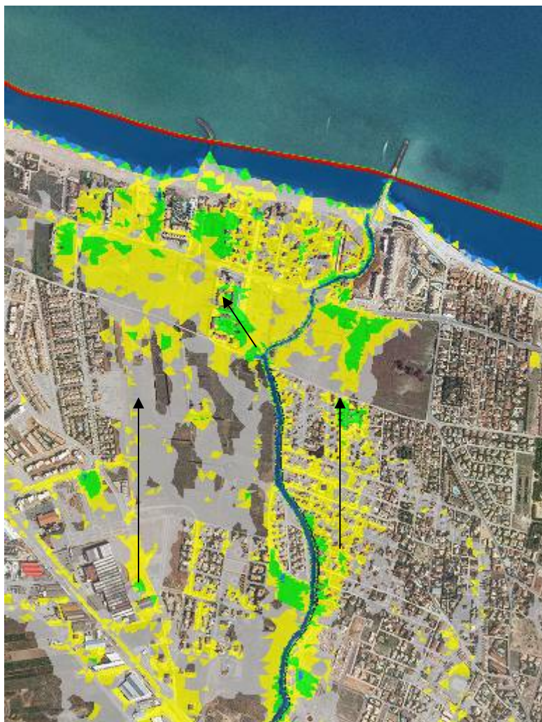
Figura 66: Detalle desbordamientos del barranc de Portelles para T25 en desembocadura.
