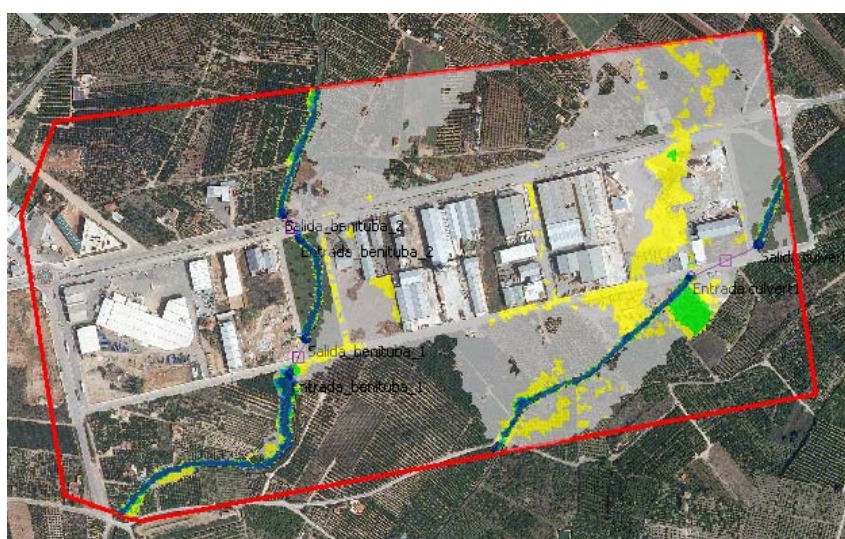
Figura 281: Detalle zona inundada en polígono industrial para periodo de retorno T500.
