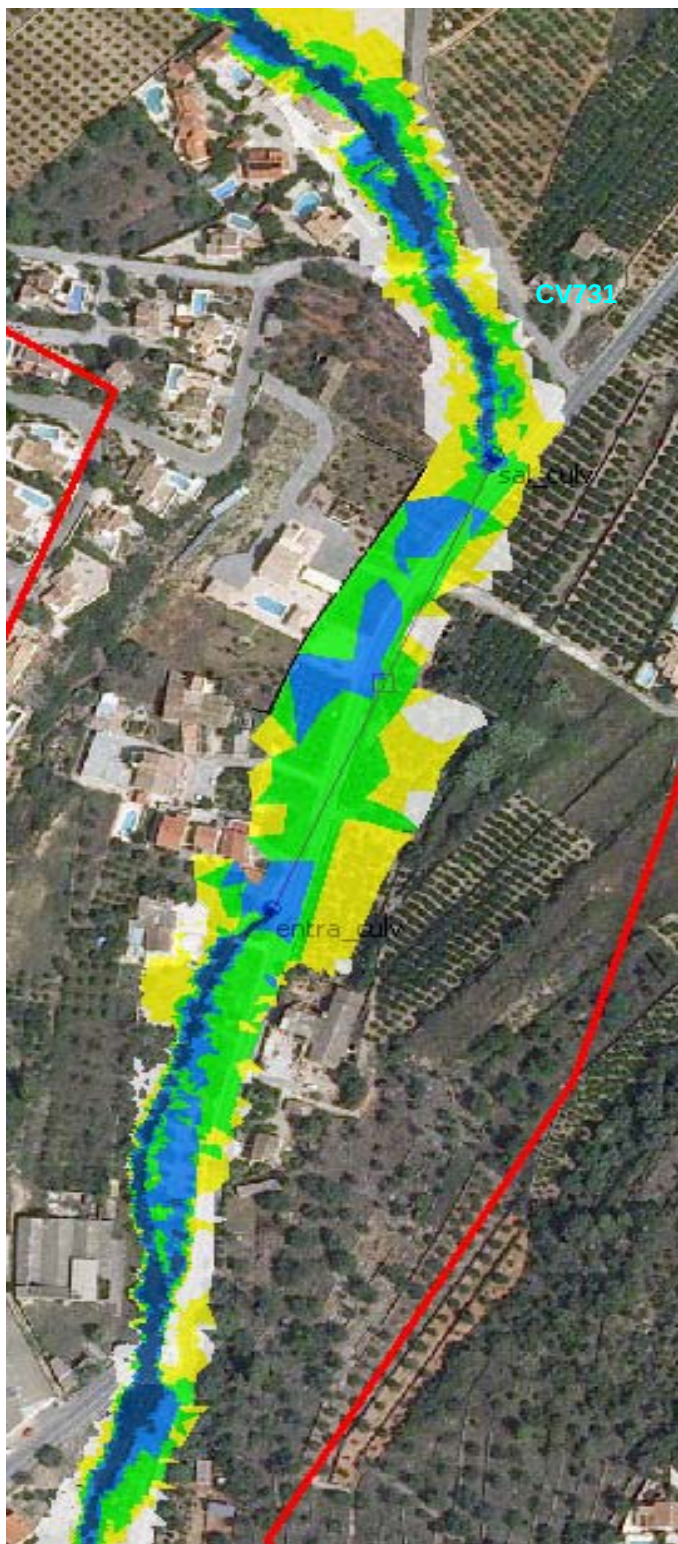
Figura 169: Simulación del modelo barranco de Orbeta para un periodo de retorno T25. Detalle desbordamientos junto a carretera CV-731
