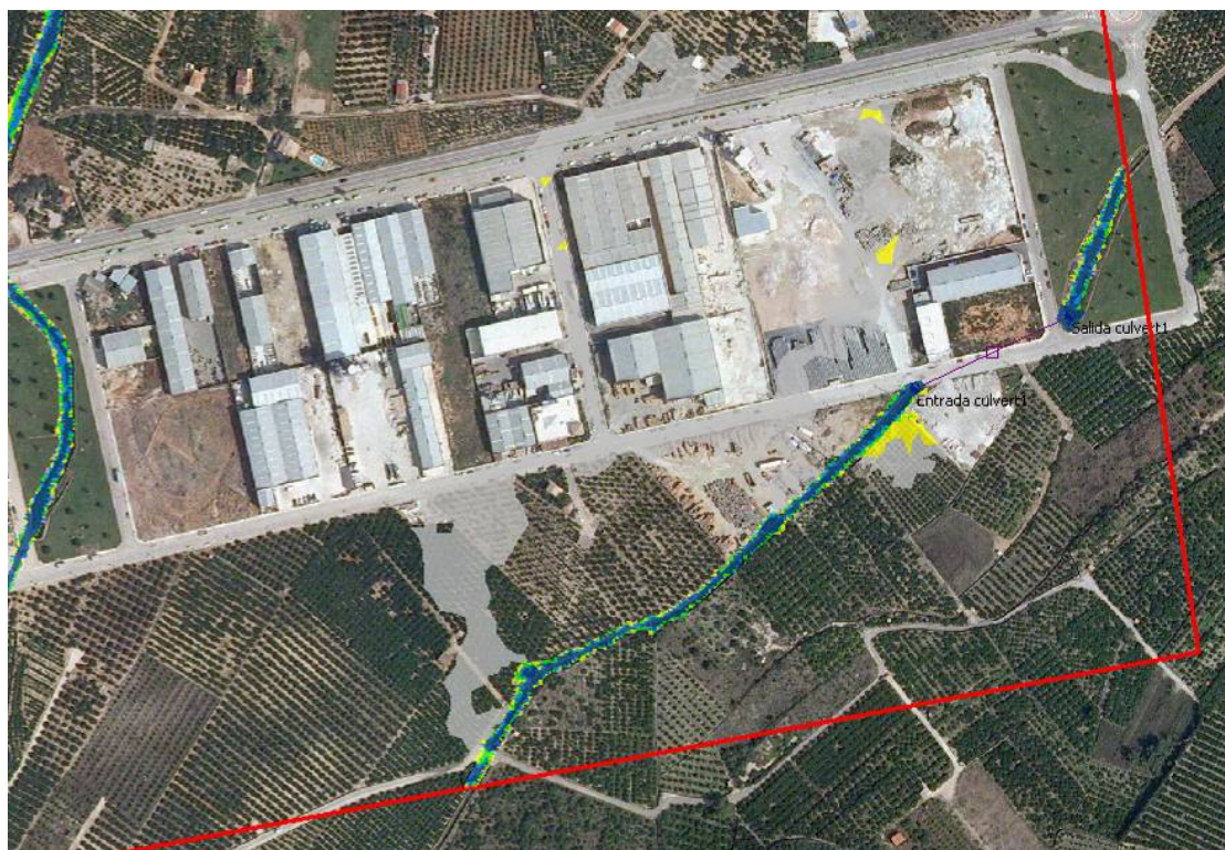
Figura 276: Desbordamiento para T50 en inmediaciones polígono industrial.
