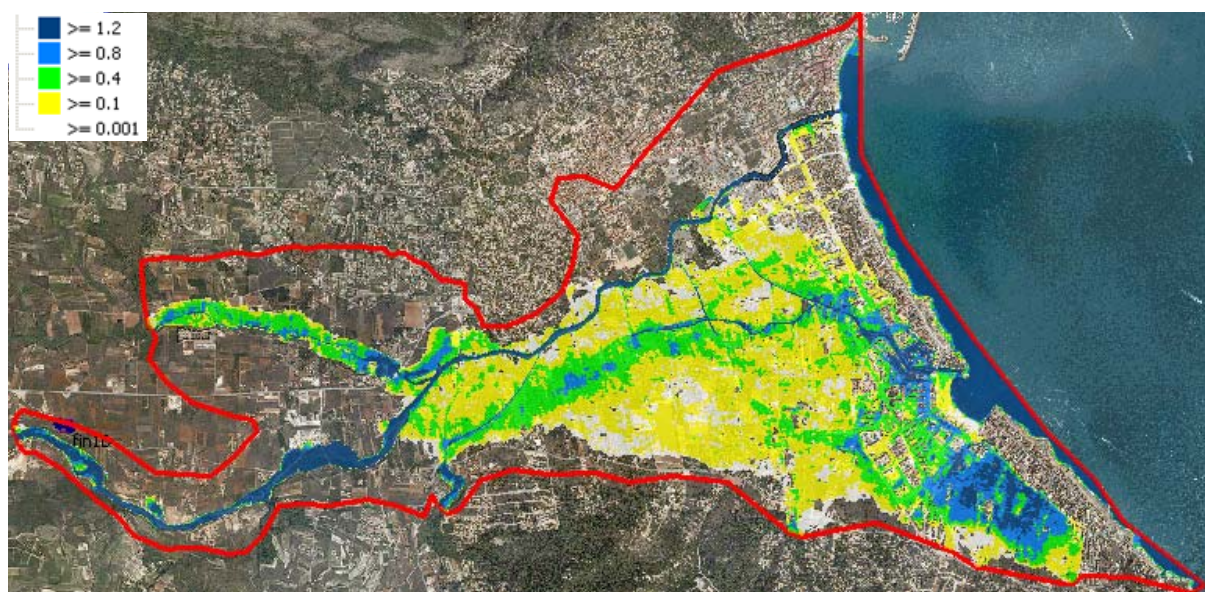
Figura 142: Simulación modelo Jávea / Xàbia para periodo de retorno T25. Evento 3-1-604
