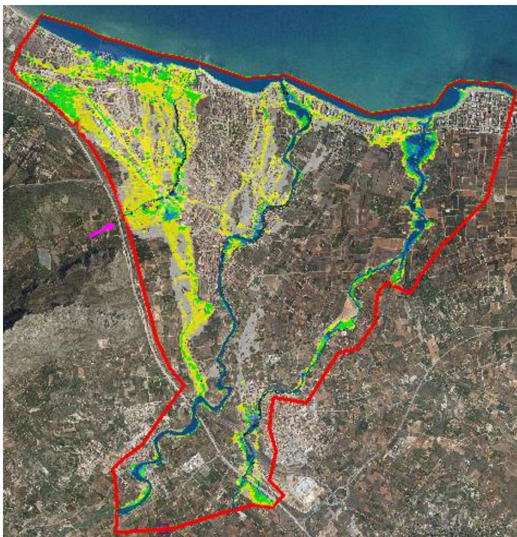
Figura 77: Simulación modelo Girona para periodo de retorno de T500. Evento 1-1-102 (Portelles).
