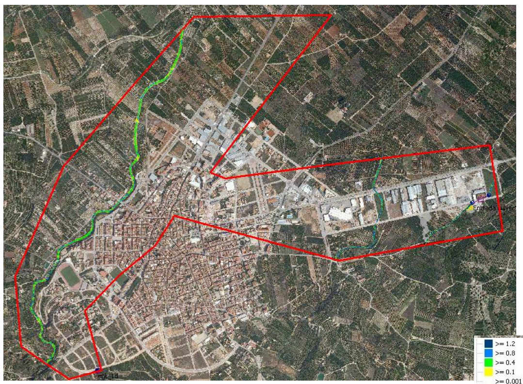
Figura 272: Simulación del modelo Pego para periodo de retorno T25.
