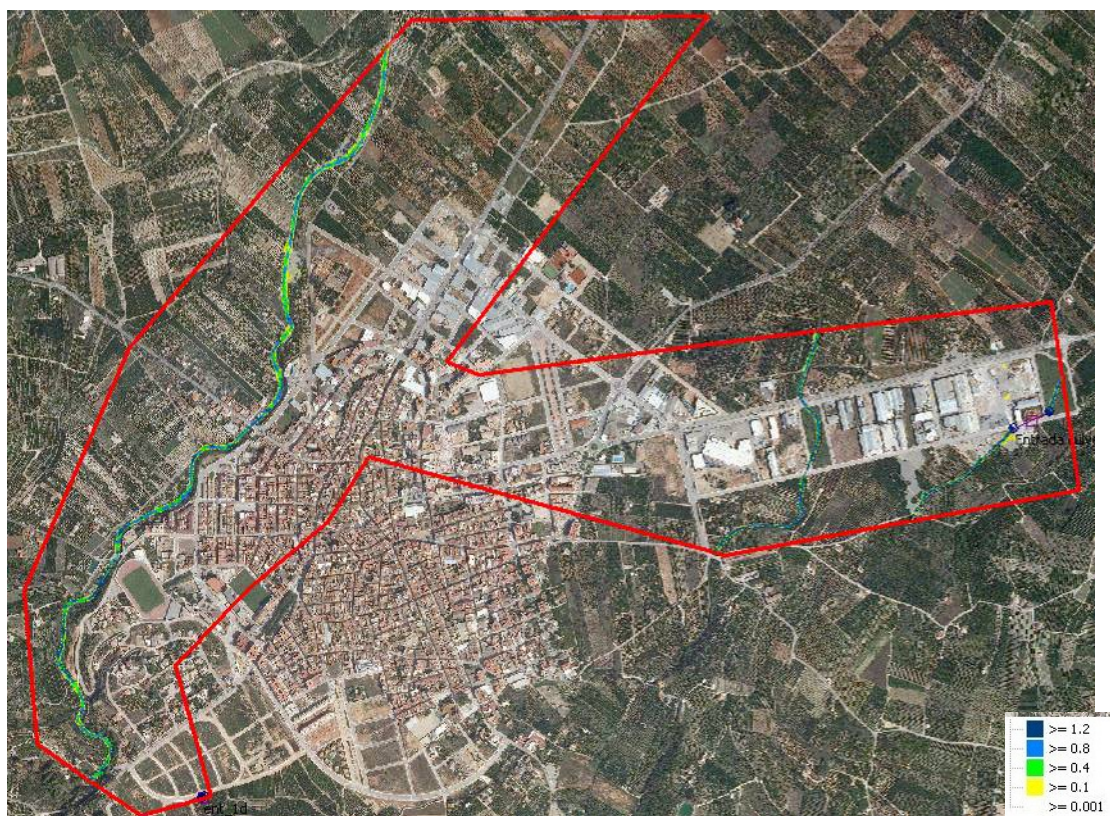
Figura 275: Simulación del modelo Pegu para periodo de retorno T50.
