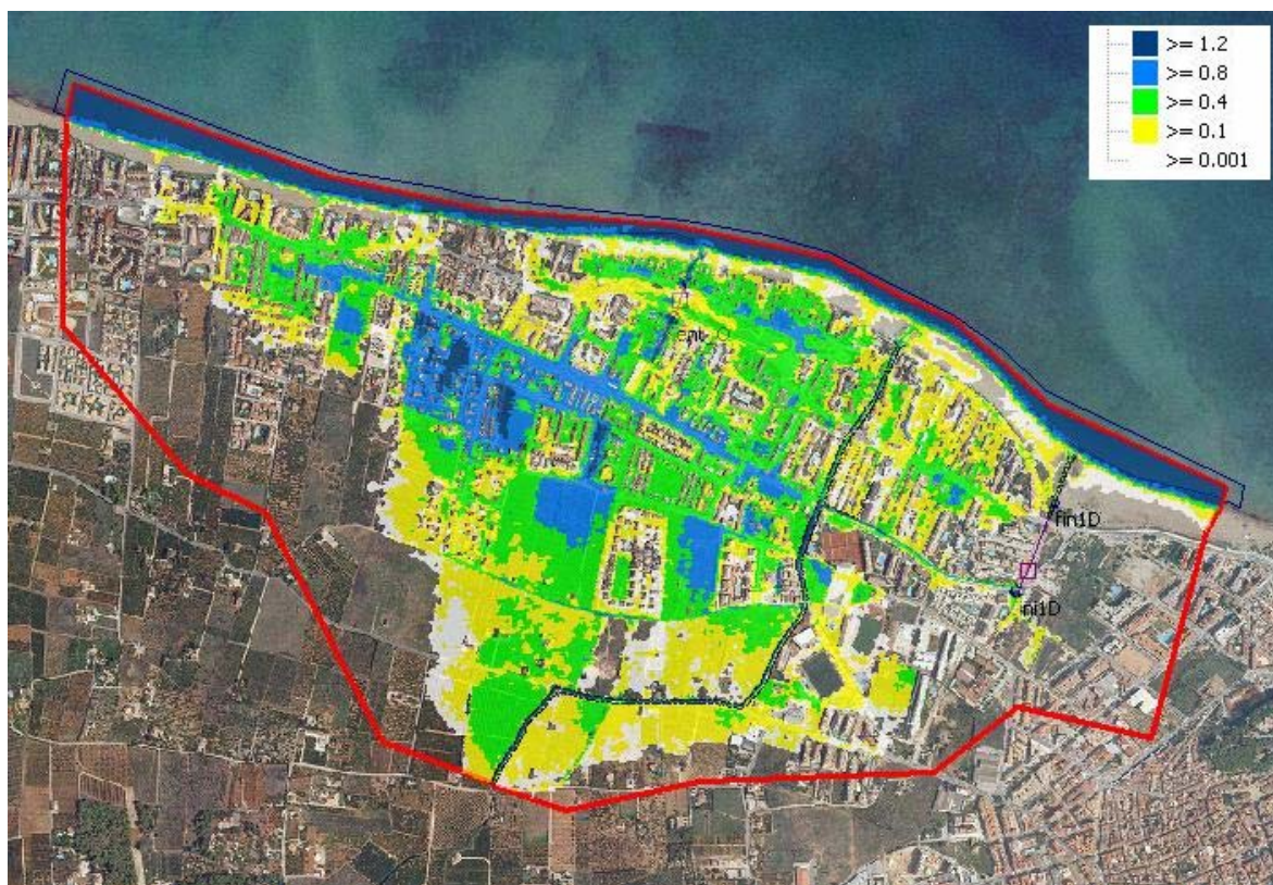
Figura 109: Simulación modelo barranco del Regatxo para periodo de retorno T100. Evento 2-2-163
