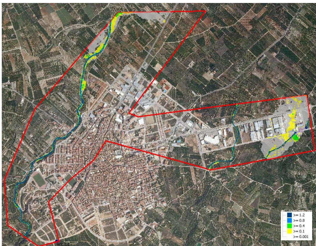
Figura 280: Simulación del modelo Pegu para periodo de retorno T500.
