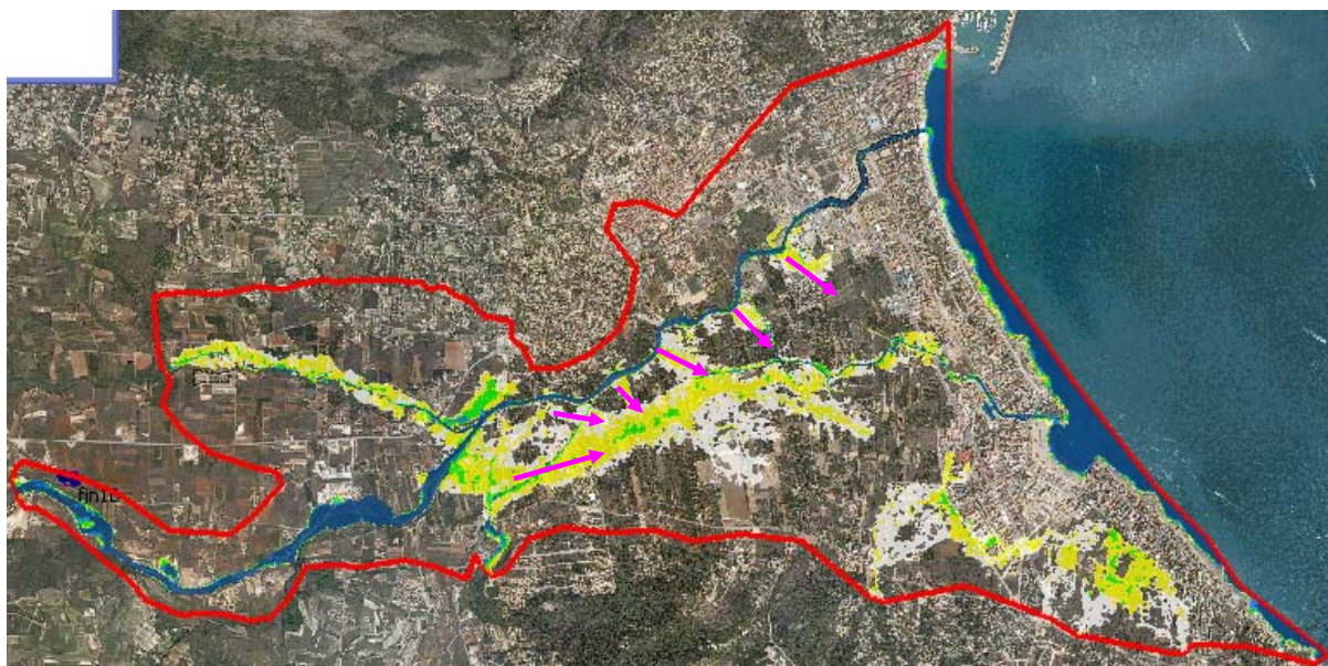
Figura 143: Simulación modelo Jávea / Xàbia para periodo de retorno T25. Inicio desbordamientos río Gorgos.
