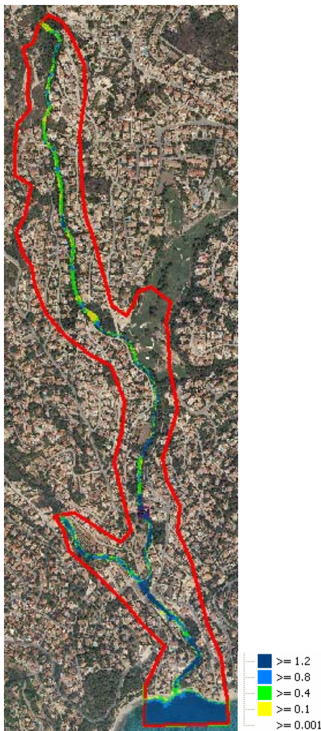
Figura 215: Simulación modelo Benissa 1 para periodo de retorno T25.
