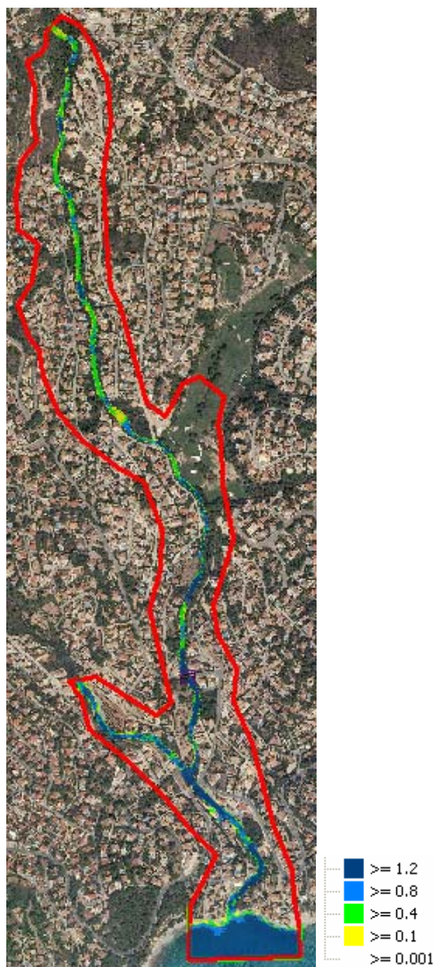
Figura 216: Simulación modelo Benissa 1 para periodo de retorno T50.
