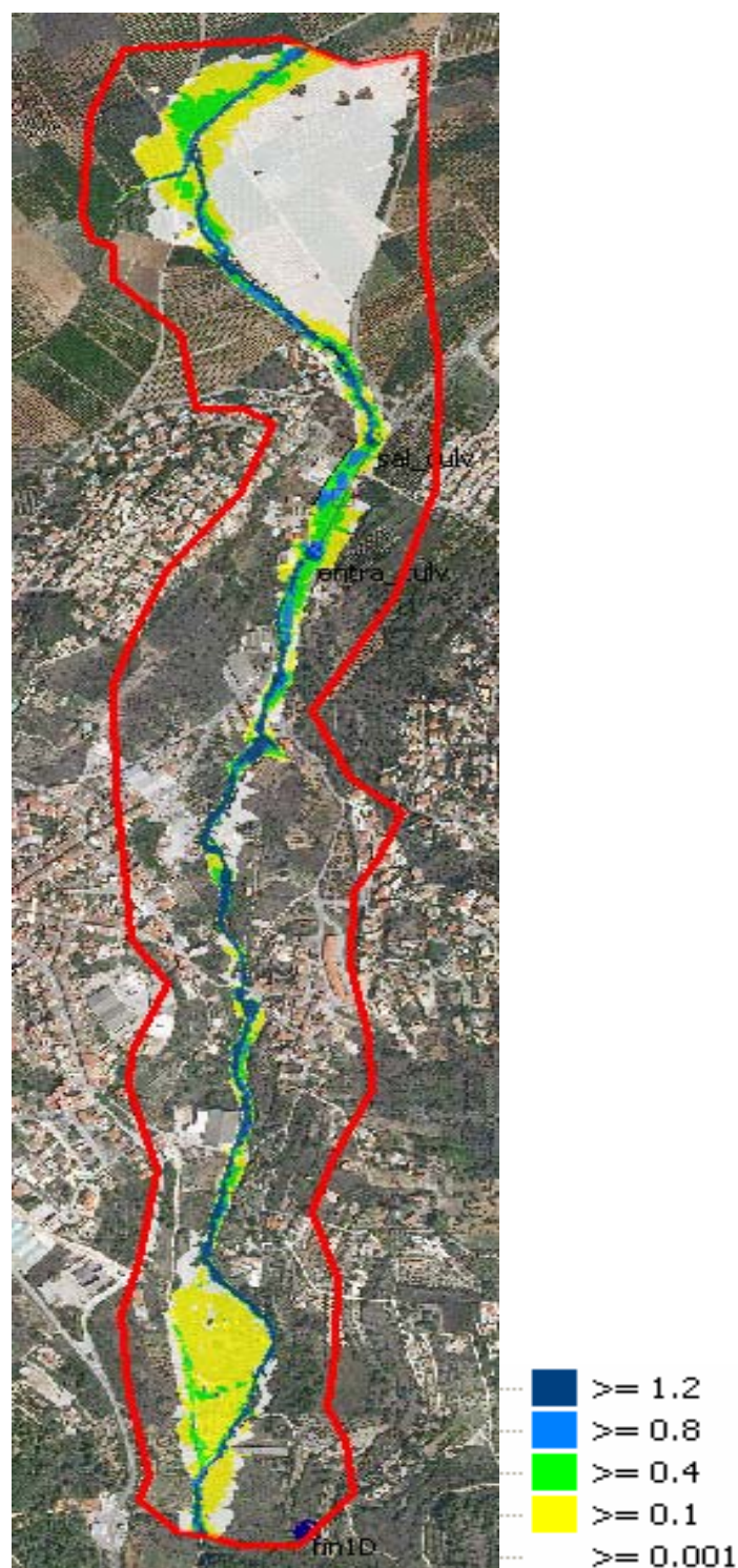
Figura 168: Simulación del modelo barranco de Orbeta para un periodo de retorno T25.
