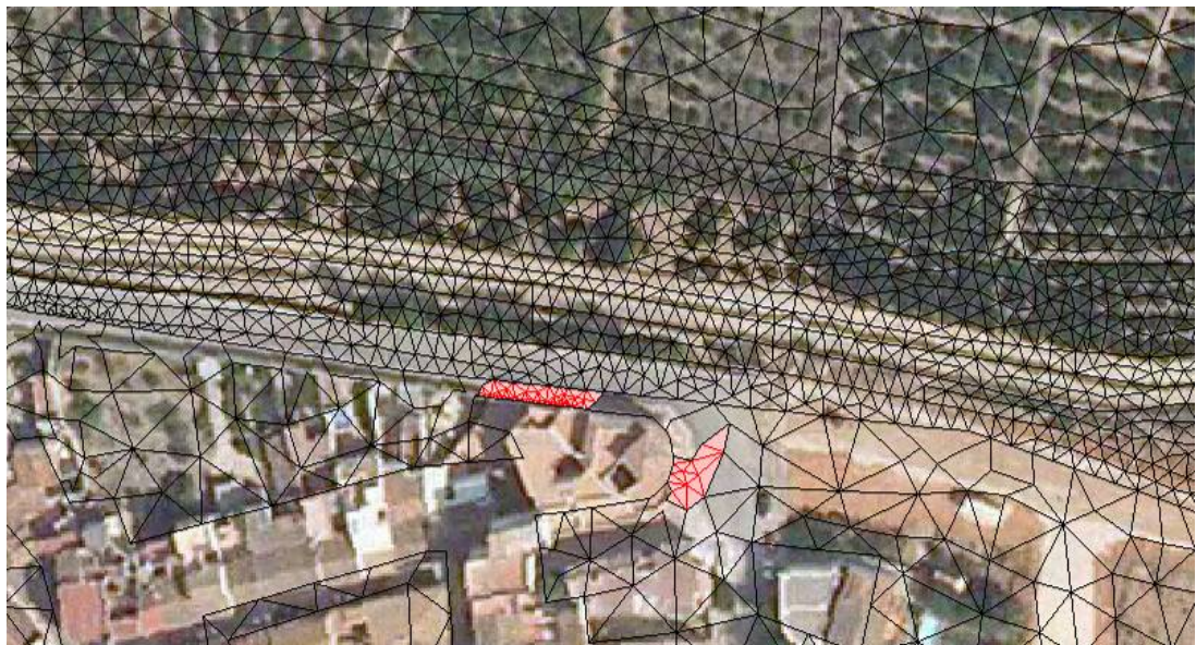
Figura 11: Elementos irregulares del mallado
