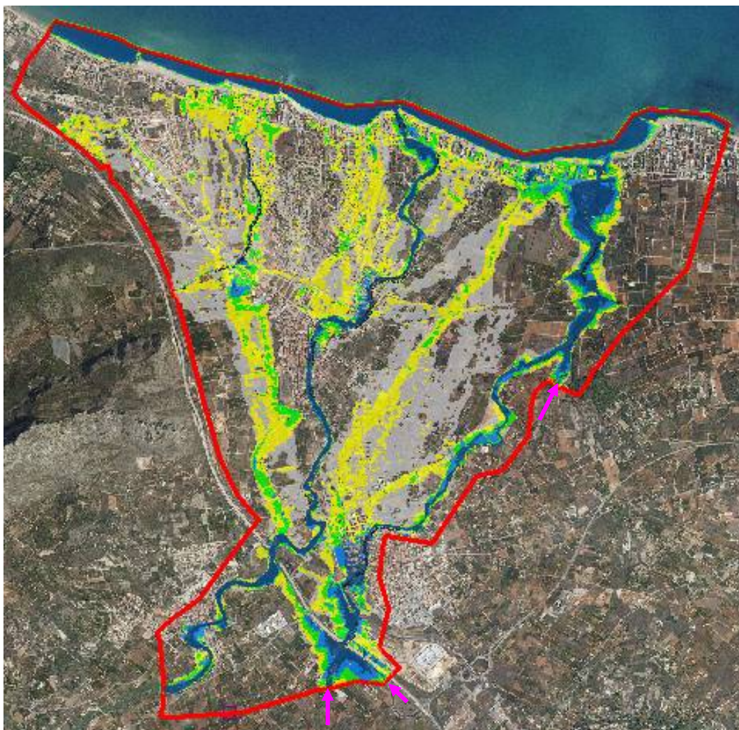
Figura 78: Simulación modelo Girona para periodo de retorno de T500. Evento 3-3-043 (Denia1-Desembocadura la Alberca).
