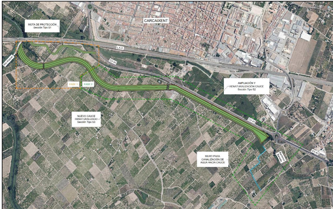
Figura 1. Obras previstas en adaptación al riesgo de inundación del Barxeta, fases I y II.
