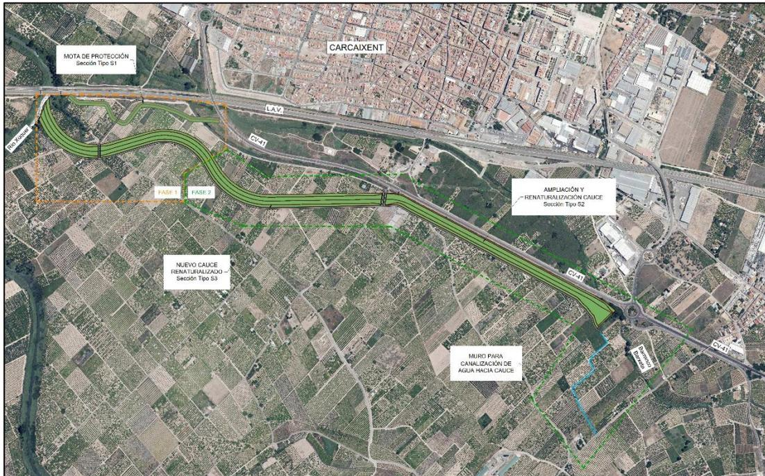
Figura 2. Obras previstas en adaptación al riesgo de inundación del Barxeta, fases I y II.
