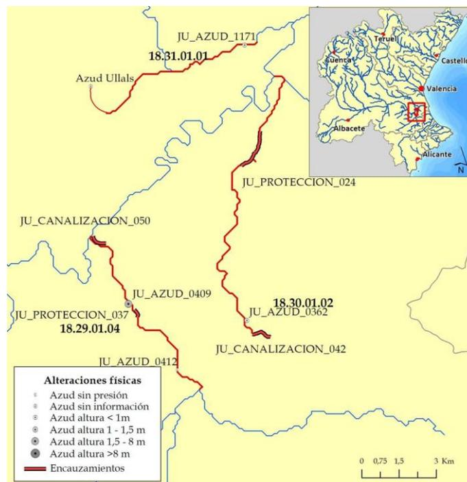
Figura 5. Localización de las presiones antrópicas en afluentes del tramo bajo del río Júcar (m.a. 18.29.01.04, 18.30.01.02 y 18.31.01.01)
