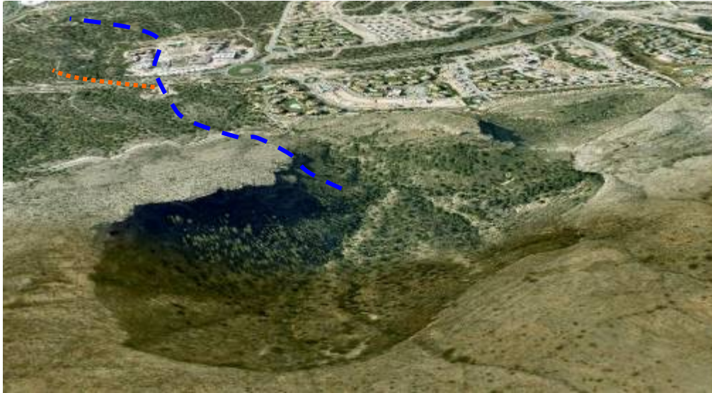
Cabecera del barranco de Cortina o Cayola, con indicación del trazado natural (azul) y el encauzamiento actual (Modificado de Google Earth).
