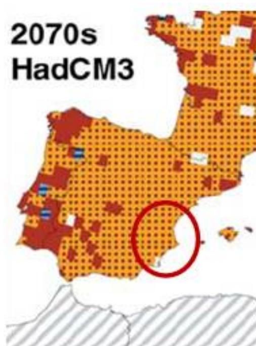
Figura 26. Regiones críticas referidas a los descensos en los periodos de retorno de sequías (naranja), de crecidas extremas (azul) o de ambas (rojo). Fuente Lehner et al., *Climatic Change* 75 (2006) p. 295
