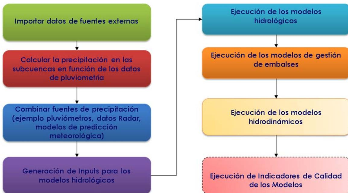
Figura 91. Diagrama de flujo del SAD de la CHJ Júcar.
